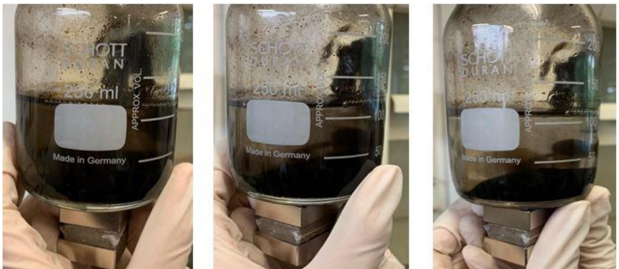
Figura 2. 52: Visualização da migração das nanopartículas magnéticas, durante a lavagem, pela utilização de vários ímanes.
