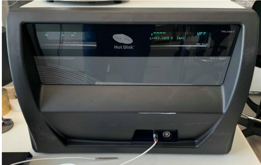
Figura 5. 4: Hot Disk TPS 2500 S, presente em Bragantia Eco Park, utilizado para medição da condutividade térmica de fluidos.
