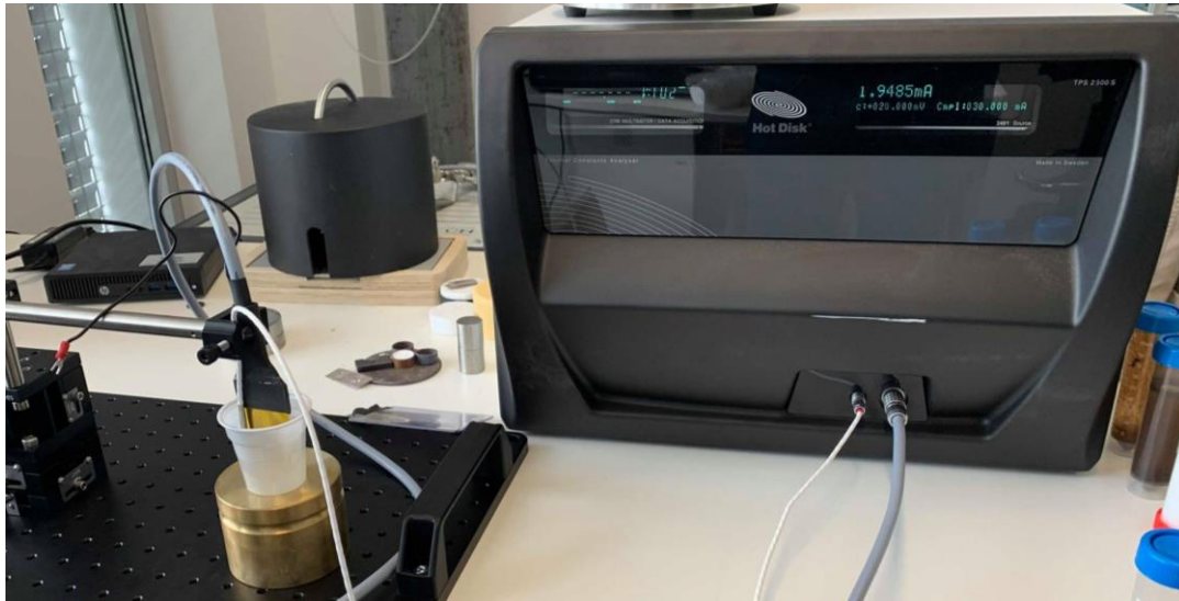
Figura 5. 6: Instalação utilizada para medição da condutividade térmica de fluido com o aparelho Hot Disk TPS 2500 S, aquando a medição.
