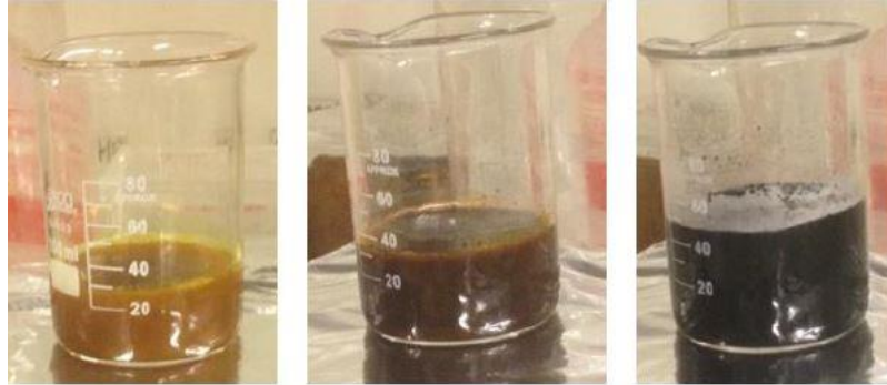
Figura 2. 51: Na figura mais da esquerda está presente apenas a solução de sais ferríticos à qual se adicionou a solução precipitadora. À sua direita, já é notória a mudança de cor, consequência da adição do hidróxido de amónia. A imagem da direita representa já a solução final contendo as nanopartículas. Deve-se ainda reparar que na solução final se pode ver a presença de vapores, fruto da reação ser exotérmica (Rocha 2018).
