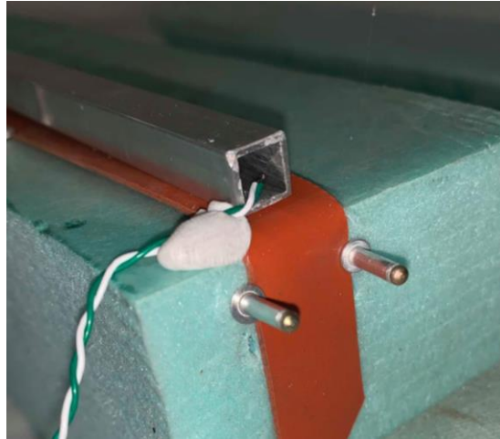
Figura 3. 8: Colocação do termopar à saída do tubo para medir a temperatura do outlet.
