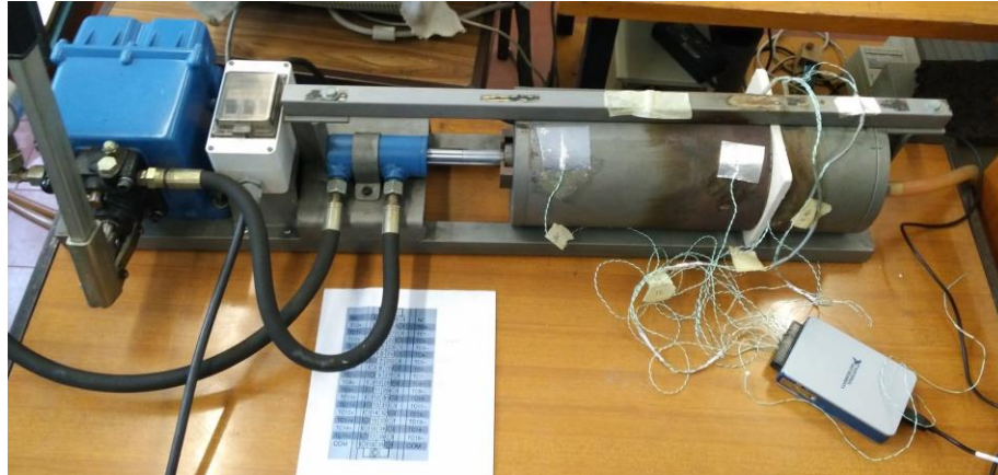
Figura 5. 11: Aspeto geral da instalação utilizada na determinação da condutividade térmica de materiais sólidos. Na imagem é possível observar a presença dos termopares e da placa de aquisição de dados.
