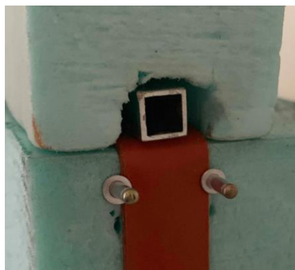
Figura 3. 10 Colocação de uma tampa de poliuretano sobre o tubo, vista de lateral.
