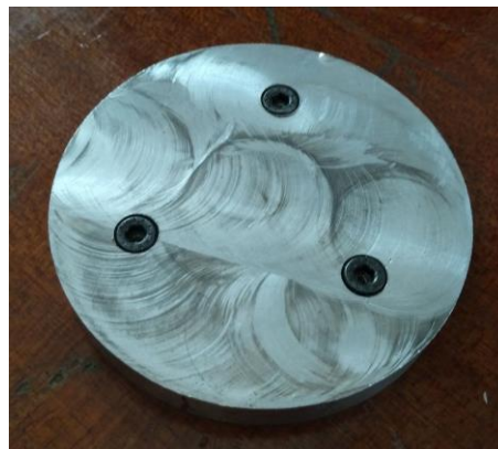
Figura 5. 15: Provete maciço, com os parafusos colocados.
