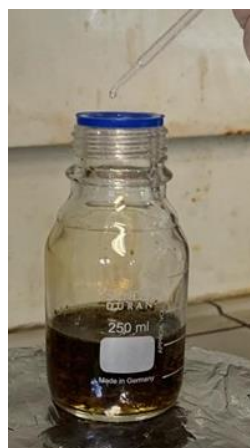
Figura 2. 50: Solução de sais ferríticos após adição da solução precipitadora.
