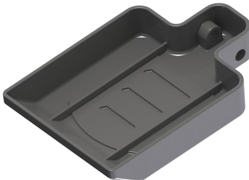
**Figura 25-** Optimização do pedal 1: Nervuras acrescentadas ao componente.
