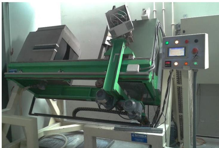
Figura 12. Máquina de moldação rotacional laboratorial do DEP.
