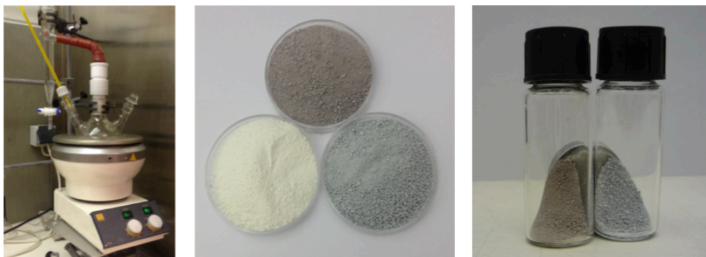
Figura 11 - Da esquerda para a direita: Montagem usada na síntese e funcionalização das microcápsulas; MCs vazias (cor branca), com incorporação de Fe (cor cinza) e com incorporação de \text{Fe}_3\text{O}_4 ; Reação das MCs com partículas magnéticas sob ação de um íman.
