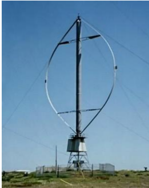
Figura 2.1 - Turbina de eixo vertical [36]
