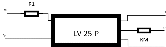
Figura 4.4 - Esquema elétrico do componente LV 25-P
