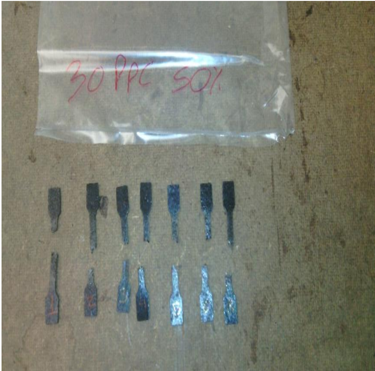
Figura 43 - Provetes dos ensaios de tração condição C50P30
