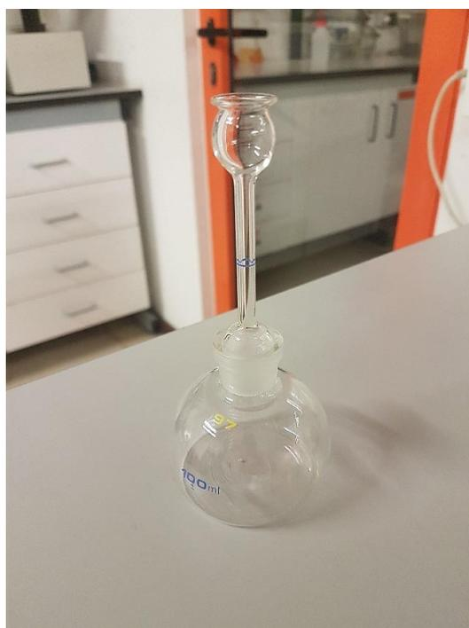
**Figura 3.13** - Picnómetro utilizado.
