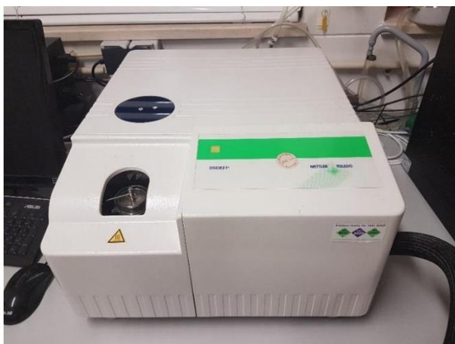
**Figura 3.12** - Equipamento de CDV utilizado.
