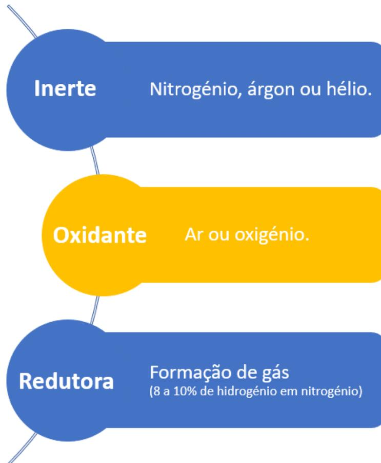
**Figura 3.9** - Tipos de atmosferas possíveis no interior de uma termobalança [57].
