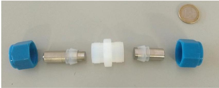
**Figura 3.3** - Célula Swagelok.
