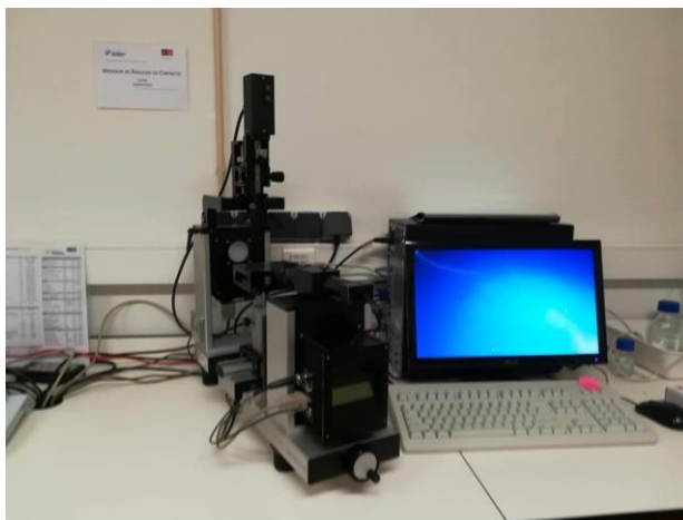
Figura 3.5 - Equipamento utilizado nas medições do ângulo de contacto: Dataphysics Contact Angle System OCA.
