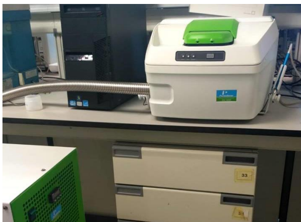
Figura 3.9 – Equipamento utilizado nos ensaios de DSC: Perkin-Elmer DSC 8000.
