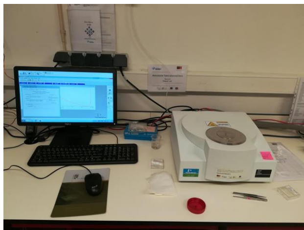
Figura 3.11 – Equipamento utilizado na análise termogravimétrica das amostras: Perkin-Elmer TGA 4000.
