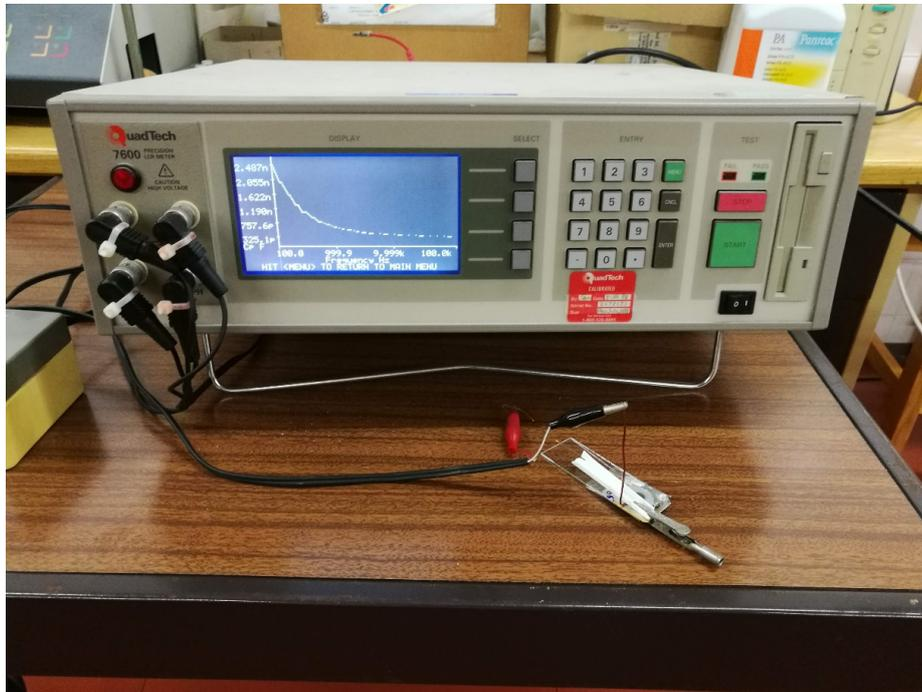
Figura 37 – Teste de varrimento e devida ligação do sensor capacitivo.
