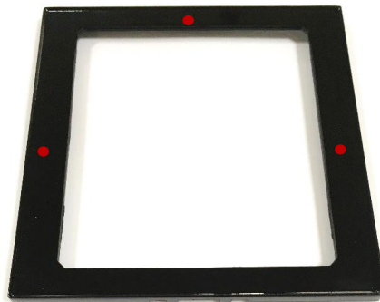
Figura 44 - Identificação dos pontos onde se efetuou a medição do brilho da tinta
