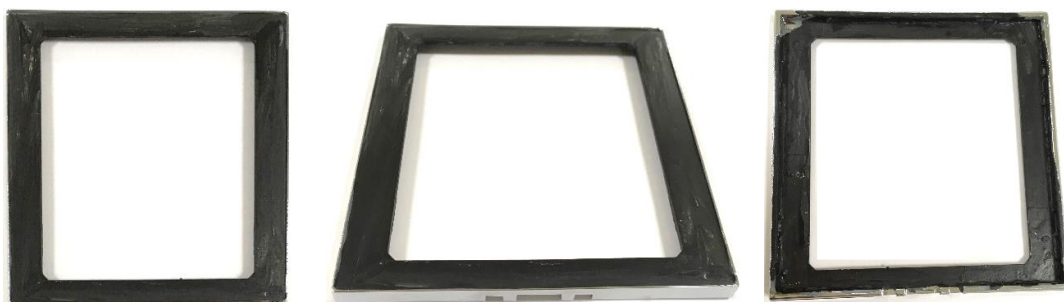
Figura 31 – Peças com tinta não condutora para consequente metalização
