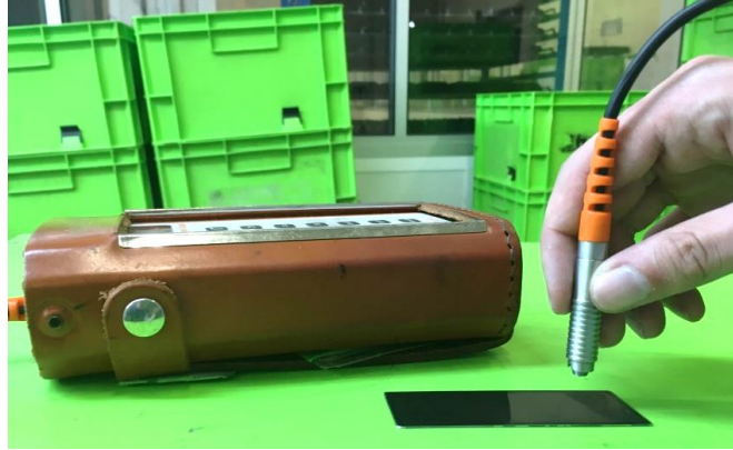
Figura 38 - Demonstração da medição da espessura do revestimento de tinta numa placa de material ferroso
