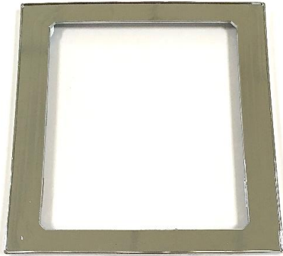
Figura 58 – Peça resultante do Cass Test
