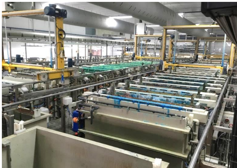
Figura 13 – Depósitos dos banhos constituintes do processo de Metalização
