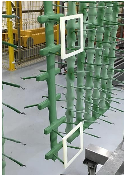
Figura 29 – Disposição das peças no rack para conseqüente processo de metalização
