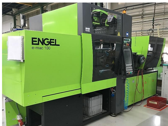
Figura 9 - Máquina de injeção
