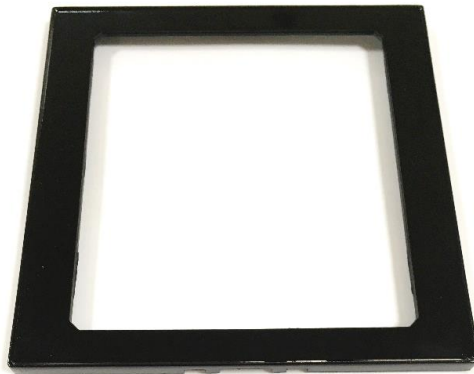
Figura 28 - Frame após revestimento de tinta com aplicação de camada top coat
