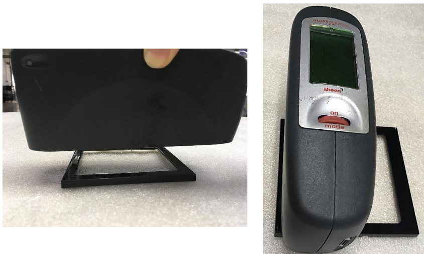
Figura 45 - Demonstração medição do brilho da tinta das peças pintadas
