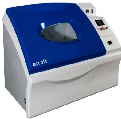
Figura 49 - Equipamento utilizado para o Teste de Corrosão – Cass Test
