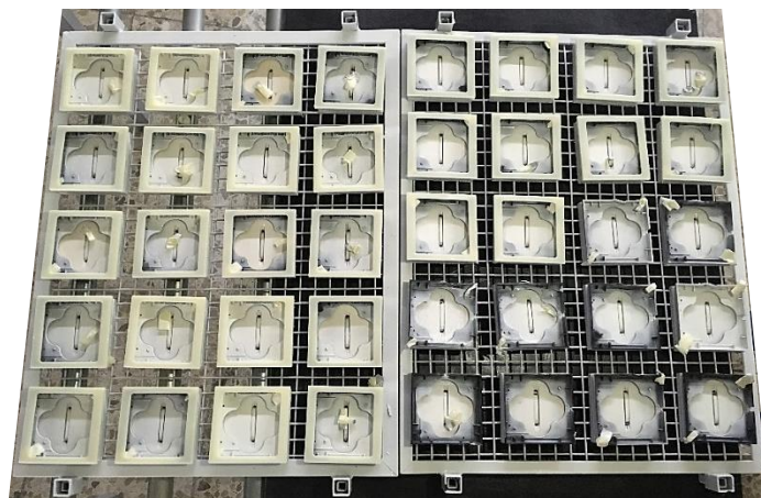
Figura 26 – Disposição das peças nos tabuleiros para o processo de Pintura
