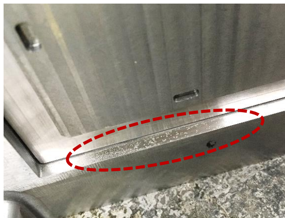
Figura 20 – Identificação do mau acabamento superficial na cavidade desenvolvida
