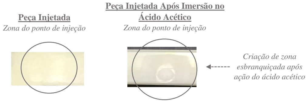
Figura 47 - Zona da peça observada em microscópio da amostra da peça injetada e da peça injetada após imersão no ácido acético
