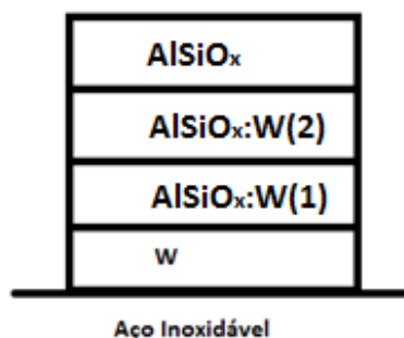
Figura 21 Esquema representativo das diferentes camadas que constituem o sistema ótico
