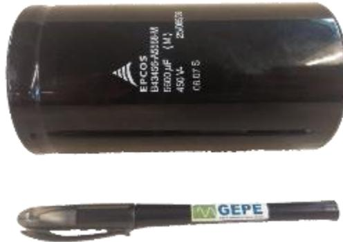
Figura 5.28 - Condensador eletrolítico utilizado no barramento CC.
