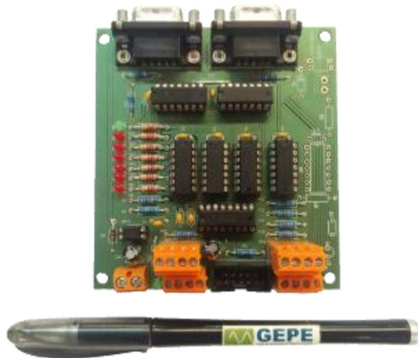
Figura 5.11 - Placa de comando monofásica.
