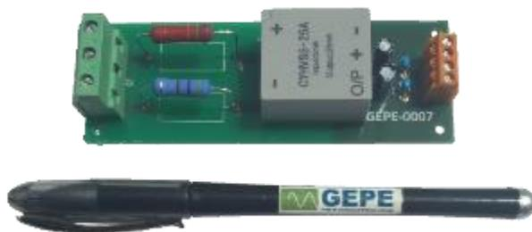
Figura 5.3 - PCB de aquisição dos sinais dos sensores de tensão CYHVS5-25.
