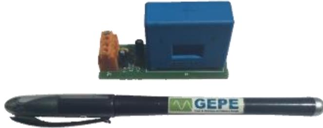
Figura 5.5 - PCB de aquisição dos sinais dos sensores de corrente LA-100P.
