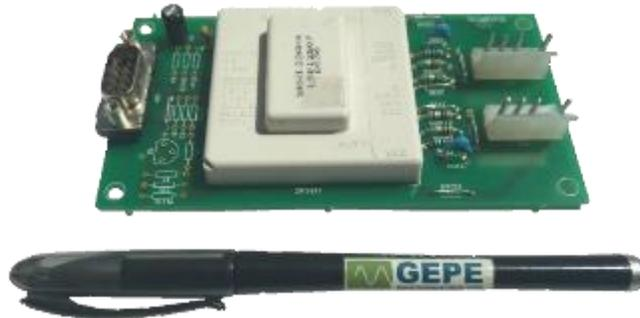
Figura 5.25 - Placa de circuito de *driver* dos IGBTs.
