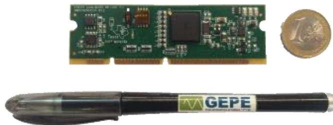
Figura 5.9 - Placa de controlo digital de sinal *TMS320F28335*.
