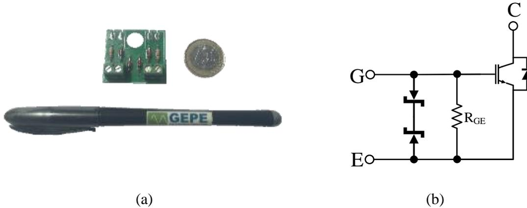
Figura 5.26 - Placa de proteção de IGBT: (a) Aspecto físico; (b) Esquema elétrico.
