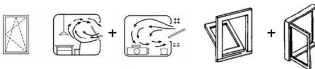
Figura 14 - Caixilho oscilo-batente (desenho, forma de ventilação e perspectiva).
