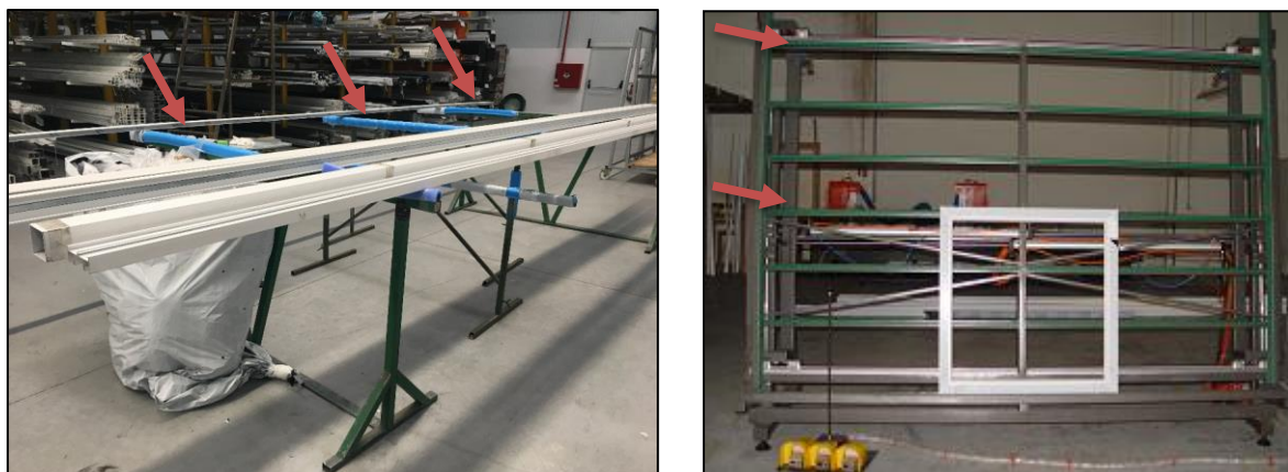
Figura 34 - Mesa (à esquerda) e mesa basculante (à direita) com proteção para os perfis.
