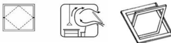
Figura 16 - Caixilho pivotante horizontal (desenho, forma de ventilação e perspectiva). (Adaptado de (Caixiave PT, 2019; HUD, 1999))
