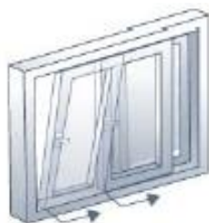
Figura 21 - Exemplificação da caixilharia oscilo-paralela de correr.
