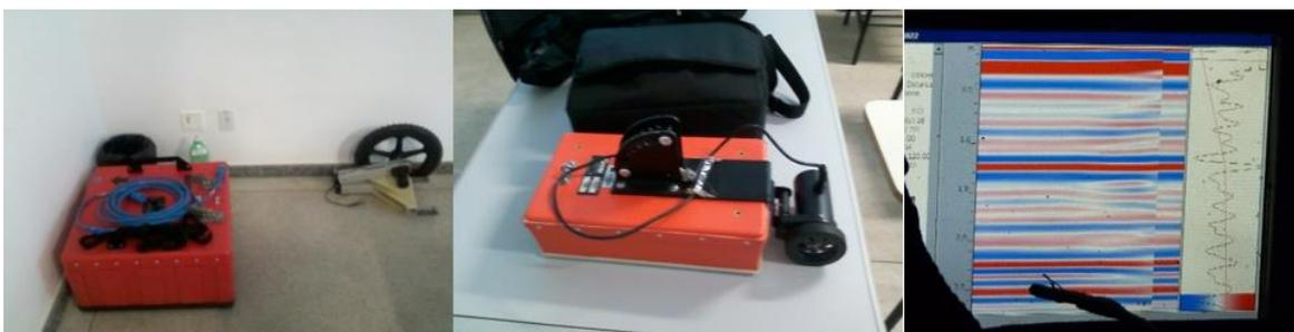
Figura 36 – Georadar de prospecção geofísica – GPR GSSI SIR 3000, com antenas blindadas de 400 MHz e 200 MHz.
