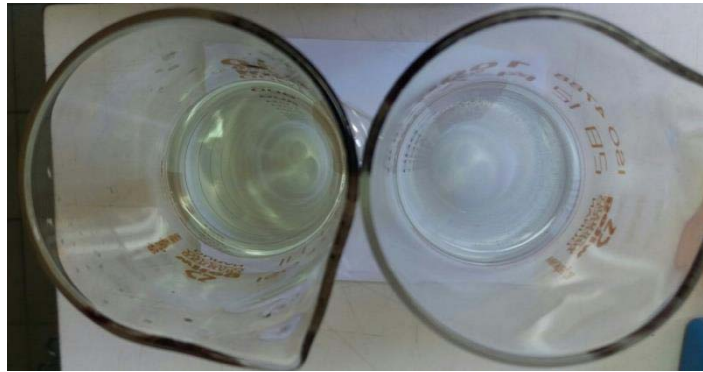
Figura 28 Condições da execução da análise visual, utilizando como exemplo uma diluição do corante amarelo. A proveta à esquerda contém a solução diluída do corante e a da direita é a proveta que contém água da torneira.
