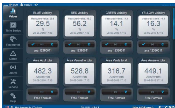
Figura 58 Captura de ecrã do ecrã do controlador onde estão apresentados, entre vários parâmetros, os parâmetros “Yellow visibility”, “Red visibility”, “Blue visibility” e “Green visibility”, no momento em que estava a ser analisada uma água tratada na ETAR, cuja cor foi classificada como “Não Visível” na diluição 1:20.
