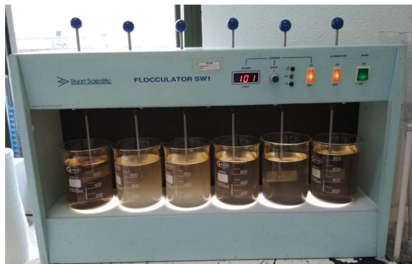
Figura 30 Alíquotas da amostra de água residual pronta a ser descarregada no meio hídrico, no floculador, sob o tratamento de coagulação/floculação.
