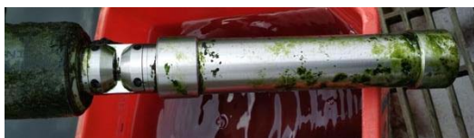
Figura 32 Sonda espectrofotométrica spectro::lyser , fabricada pela s::can , instalada na ETAR de Rabada.
