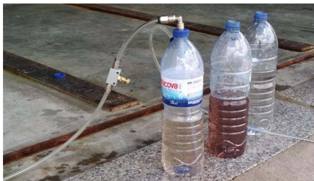
Figura 31 Sistema de montagem para a ozonização da amostra de água residual tratada na ETAR de Rabada.
