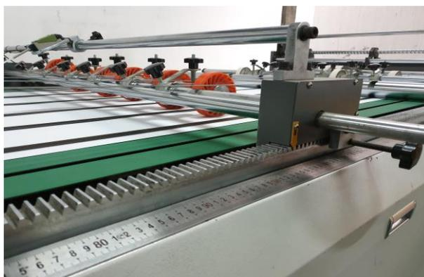
Figura 59 Réguas para posicionar rodas/guias de transporte da máquina ML 2.04
