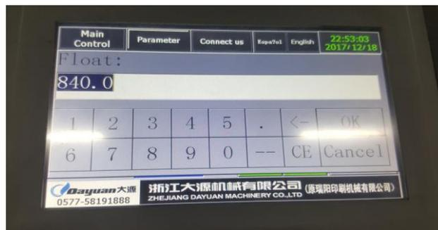
Figura 47 Painel de controlo da máquina de corte - Campo de colocação do comprimento do plano
