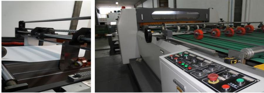
Figura 48 À esquerda: Paralelas de saída; À direita: rodas/guias de transporte do equipamento ML 2.04
