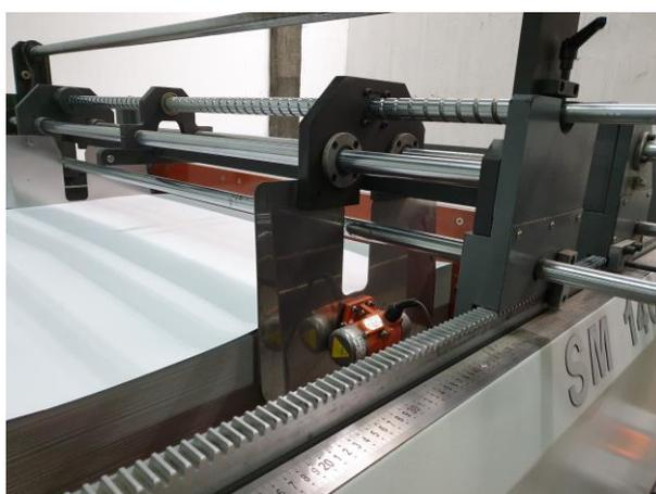
Figura 60 Régua para posicionar paralelas de saída do equipamento ML 2.04
