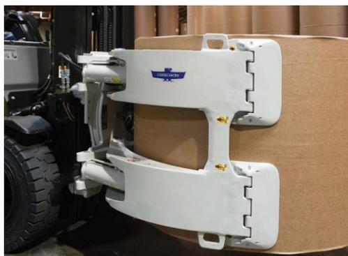
Figura 67 Exemplo de uma bobine suportada por um empilhador *Clamp*
