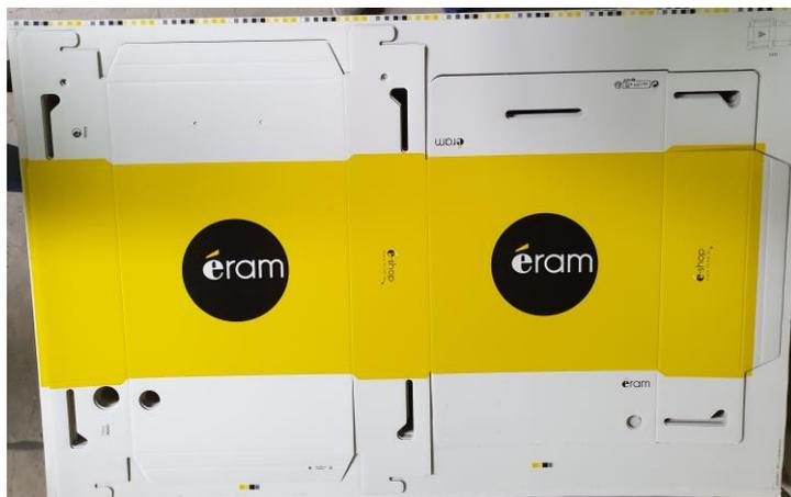
Figura 29 Exemplo de um plano após operação de Corte e Vinco
