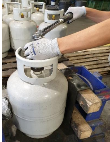
Figura 48: Medição do binário com chave.
