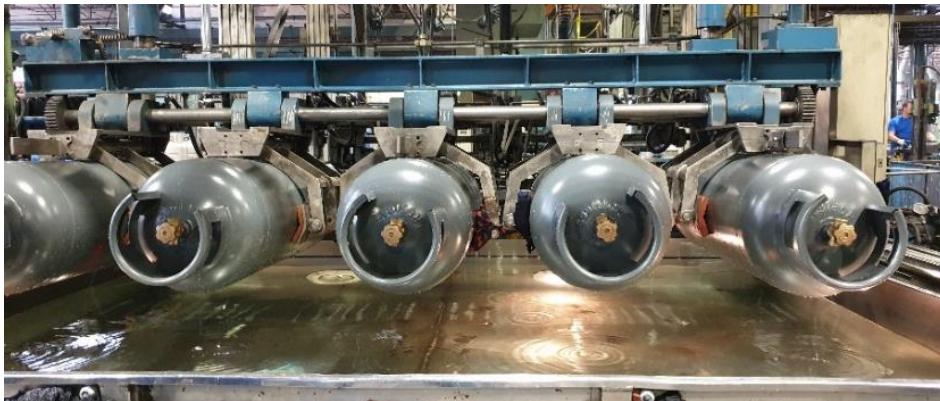
Figura 34: Ensaio de Fugacidade (tanque com água onde as garrafas são mergulhadas)
