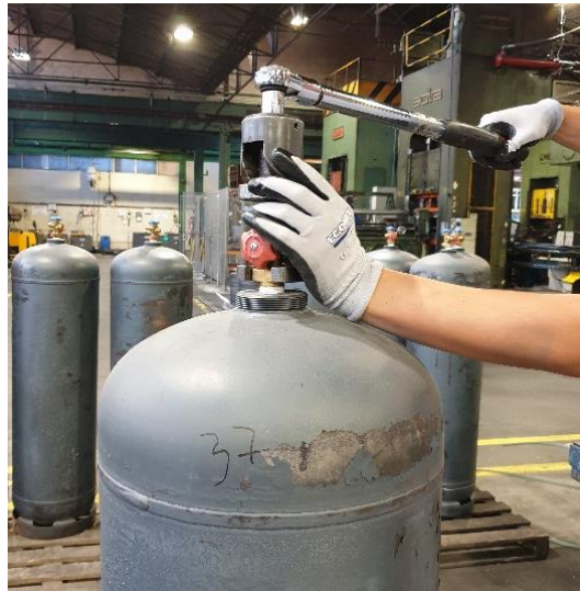
Figura 42: Medição do binário com chave.
