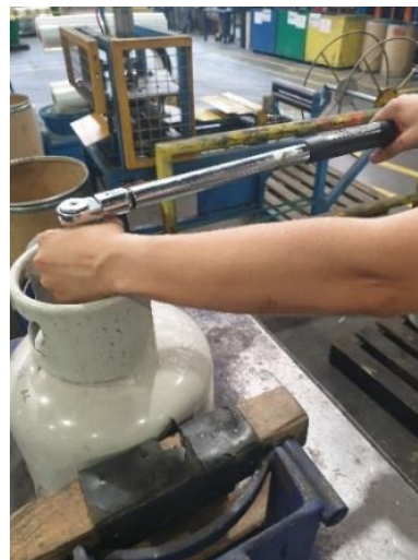
(b) Medição manual do binário com chave
