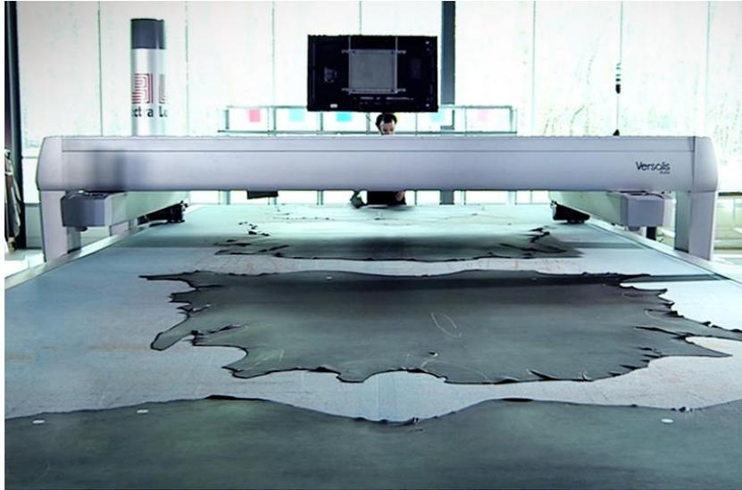
Figura 8 – Máquina de corte de couro automático - Versalis
