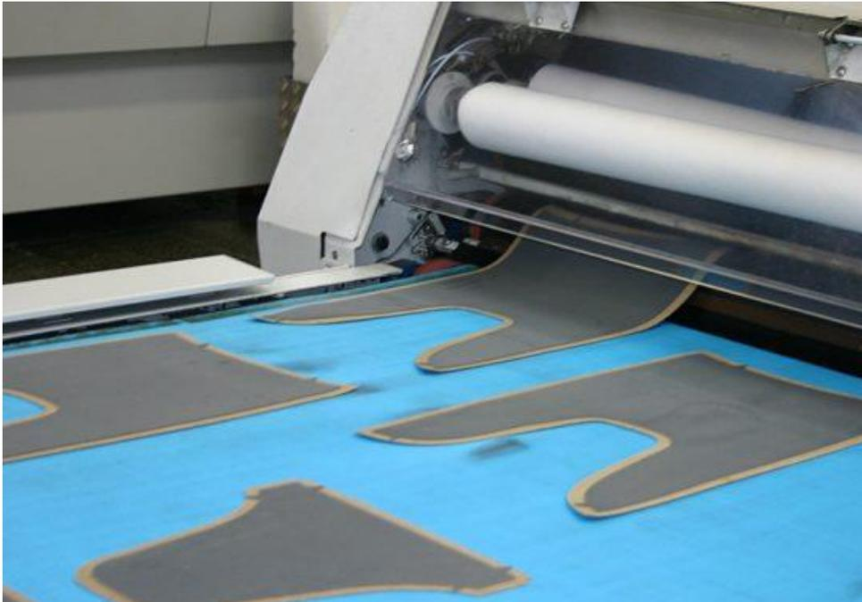
*Figura 12 - Output da laminação (peças termocoladas)*
