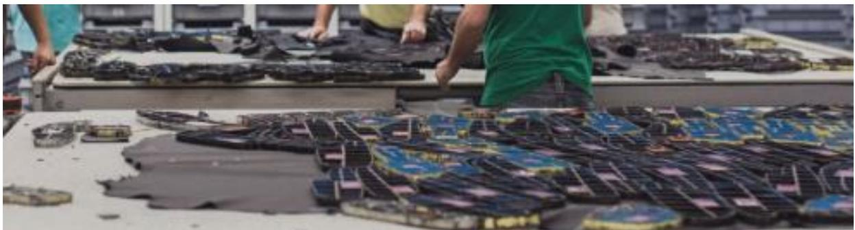
*Figura 7 – Nesting (corte de couro com cortantes)*
