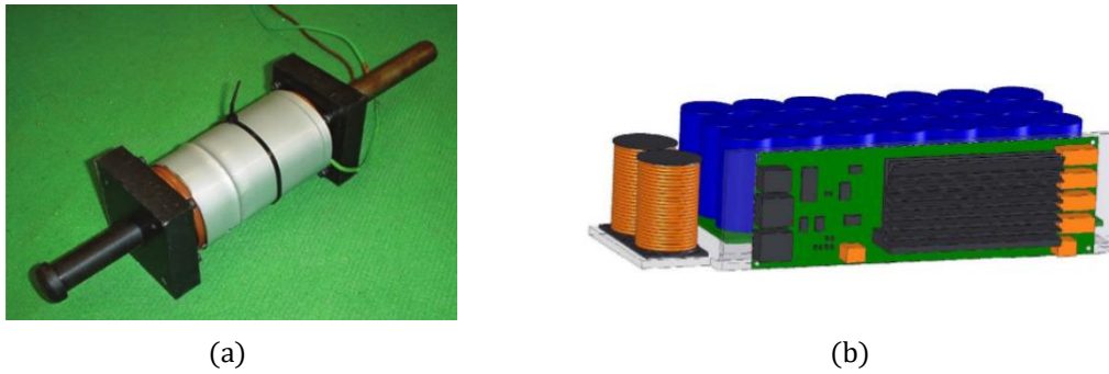
Figura 4.2 – Chuto eletromagnético. (a) Bobina eletromagnética [12]. (b) Representação CAD da bateria de condensadores (cilindros azuis), das bobinas de recarga (os dois cilindros à esquerda) e da placa controladora (a verde) [11].
