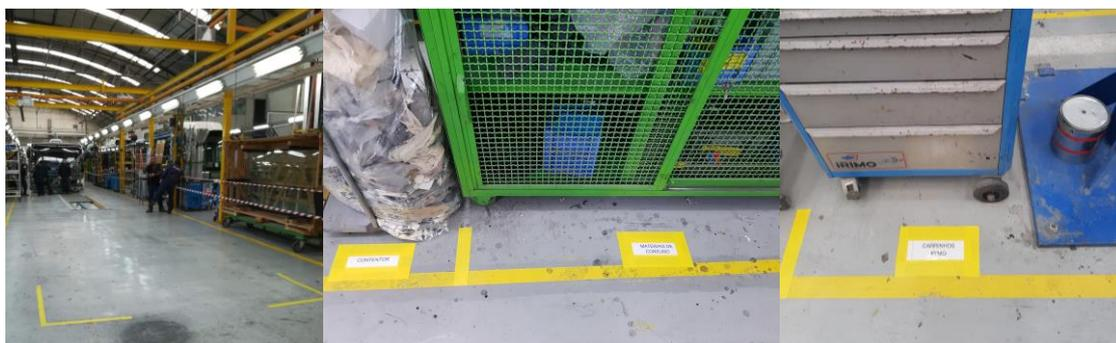
*Figura 53 - Marcas feitas no chão para guiar a posição do autocarro e exemplos de etiquetas para o local dos items no posto*
