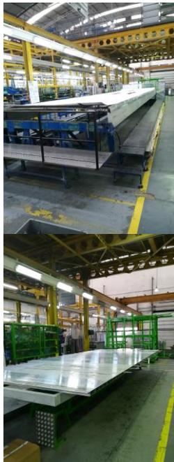
Nesta primeira etapa é feita a pré-montagem dos painéis laterais, do tejadilho e do pavimento em alumínio. Estas estruturas serão montadas posteriormente em cima do chassi e irão constituir a estrutura do autocarro.
