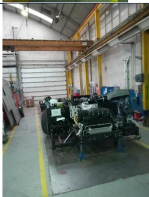
No primeiro posto o principal foco é a preparação do chassi que chega separado em duas partes. Fazer o alinhamento do autocarro, a pneumática e aplicar o estrado de alumínio são algumas das tarefas que também acontecem aqui.
