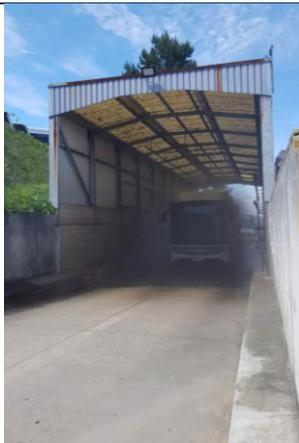
O teste do chuveiro consiste em 30 minutos onde o autocarro está debaixo de dispersores de água. O objetivo é detetar fugas de entrada de água tanto na estrutura como nas portas.
