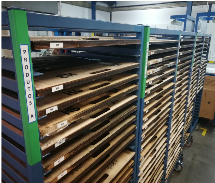
Figura 53 - Sinalização das localizações destinadas às ferramentas da classe A da máquina HAWKES
