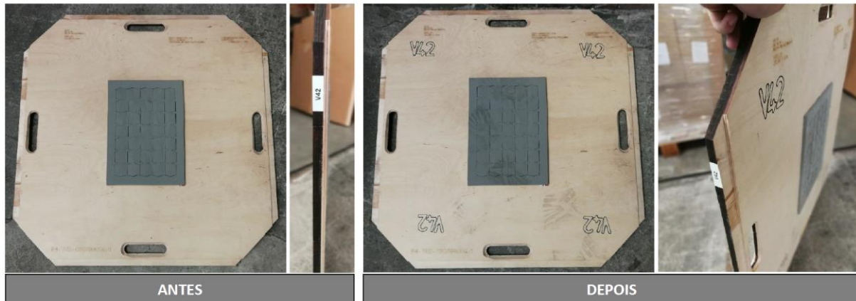
Figura 54 - Método de identificação das ferramentas de corte, antes e depois
