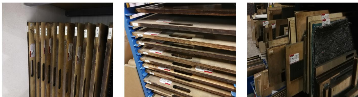
Figura 41 - Sinalização das ferramentas desnecessárias utilizando Red Tags
