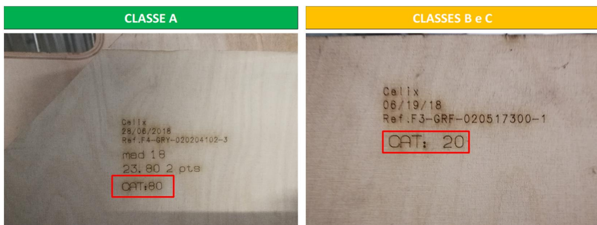
Figura 55 - Marcação da classe de produto nas ferramentas de corte
