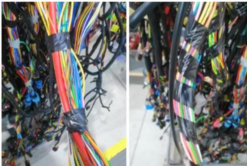
Figura 56 - Bandagem espaçada e bandagem em espiral, respetivamente.
