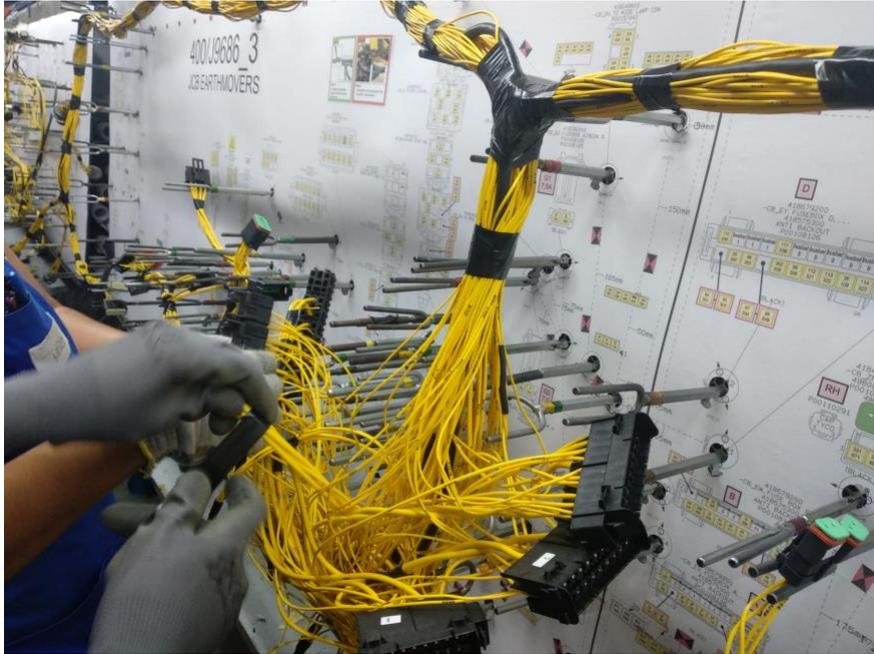
Figura 14 - Montagem de uma cablagem no chão de fábrica.
