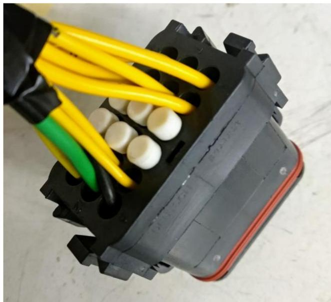
Figura 34 - Conector com seis plugs brancos.
