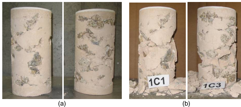
Figura 3: Provetes representativos dos panos internos: (a) provetes antes do ensaio; (b) mecanismos de colapso observados.
