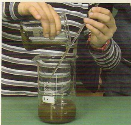
Fig. 13 Ao processo de retirar da água as substâncias em depósito chama-se decantação.
