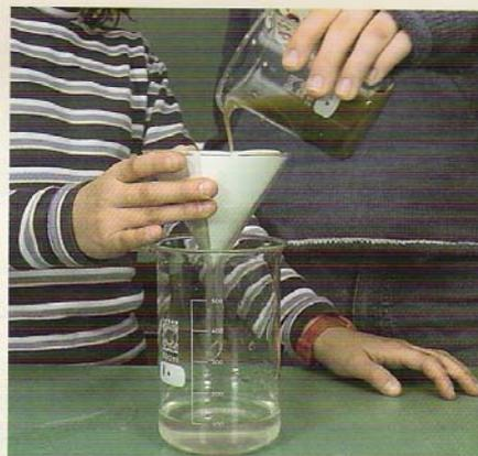
Fig. 14 Ao processo de retirar da água as substâncias em suspensão chama-se filtração.
