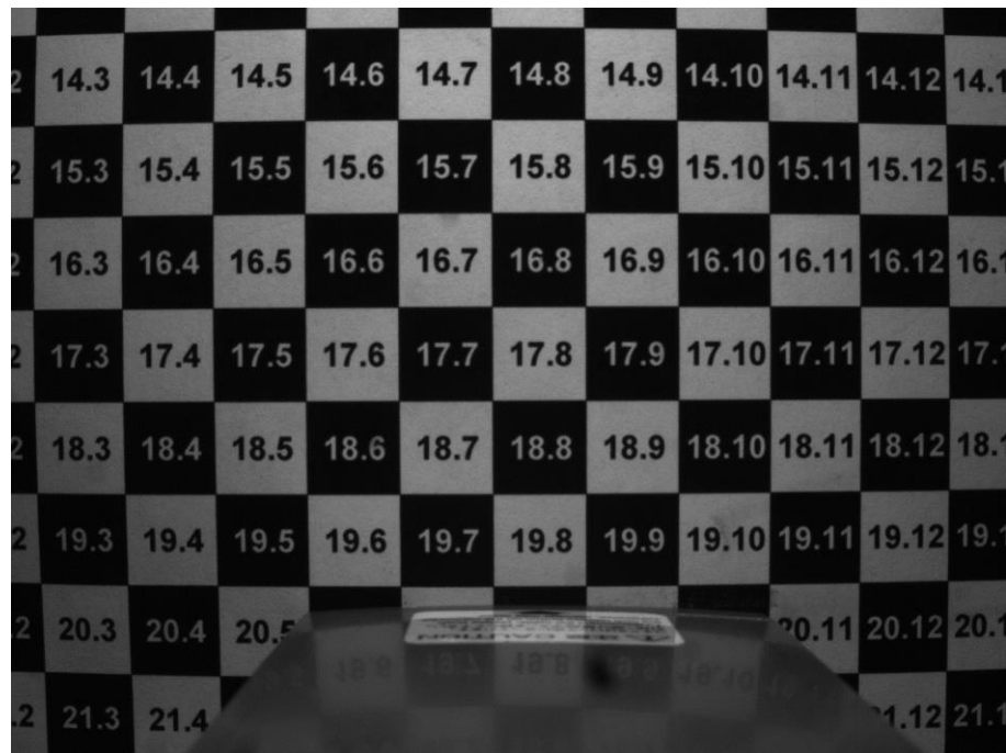
Figura A4.4 Resultado de Focus Metric intermédio (valor de 20) e distância abaixo de d_0 , com filtro vermelho
