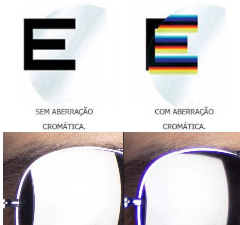
Figura 22 Dois pares de fotografias dos mesmos objetos, as da direita apresentam aberrações cromáticas ( (Motomas, 2016) e (Zack, s.d.) )
