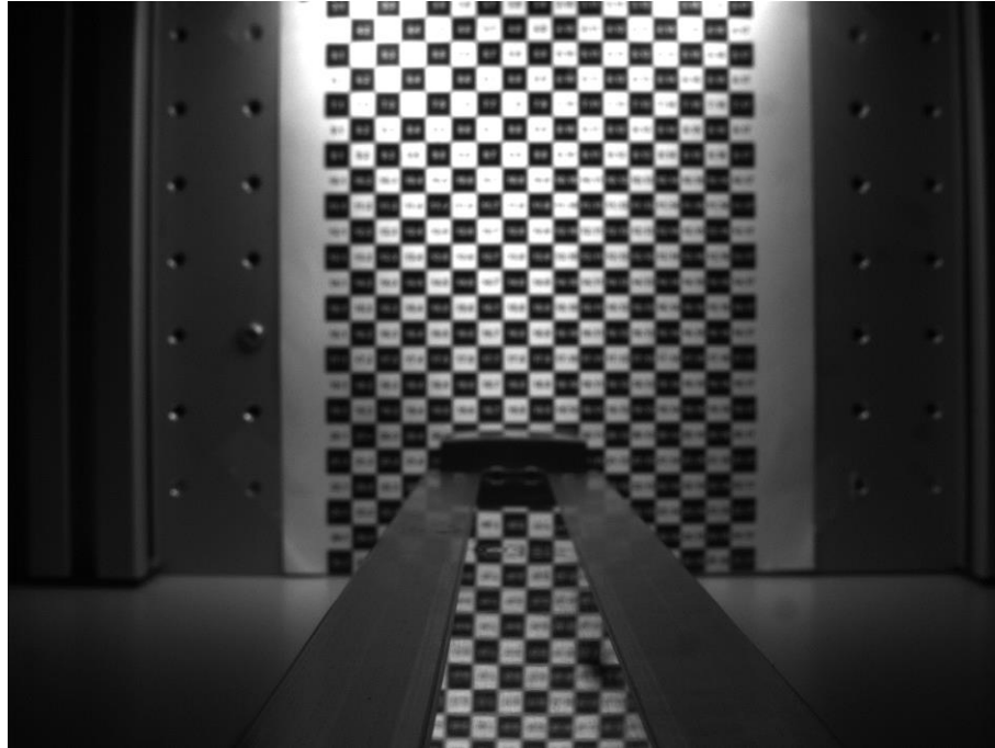
Figura A2.3 Pior resultado de Focus Metric (valor de 10,2) e distância acima de d_0 , com filtro verde
