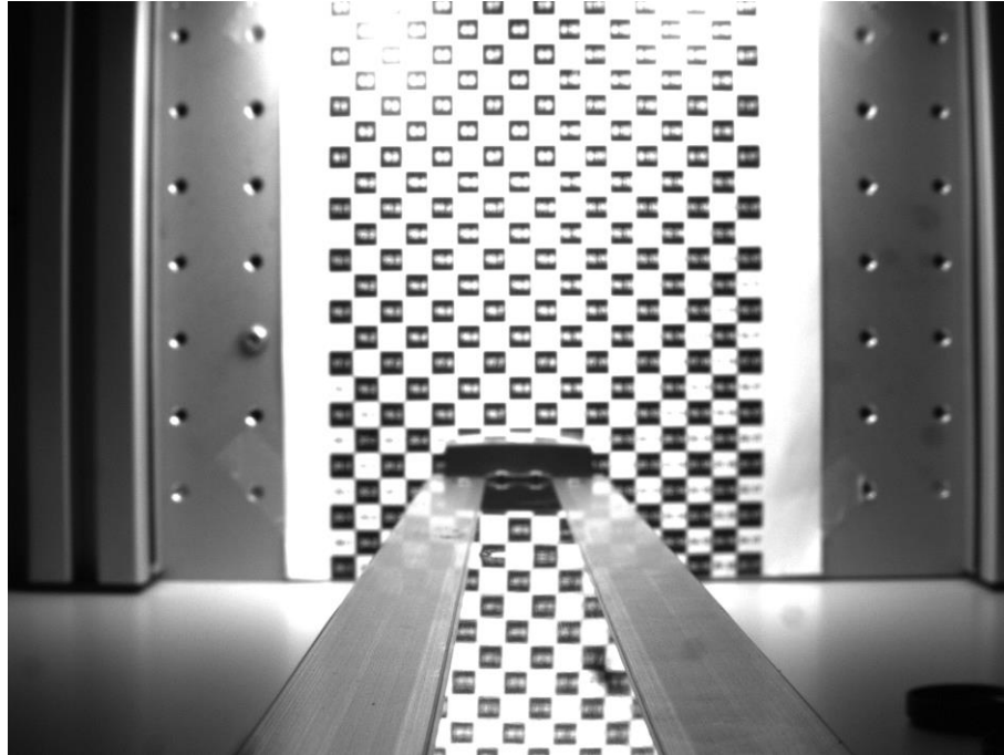
Figura A2.1 Pior resultado de Focus Metric (valor de 10,2) e distância acima de d_0 , sem filtros
