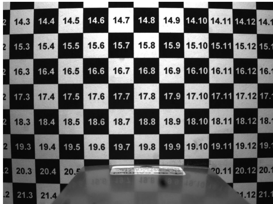
Figura A4.3 Resultado de Focus Metric intermédio (valor de 20) e distância abaixo de d_0 , com filtro verde
