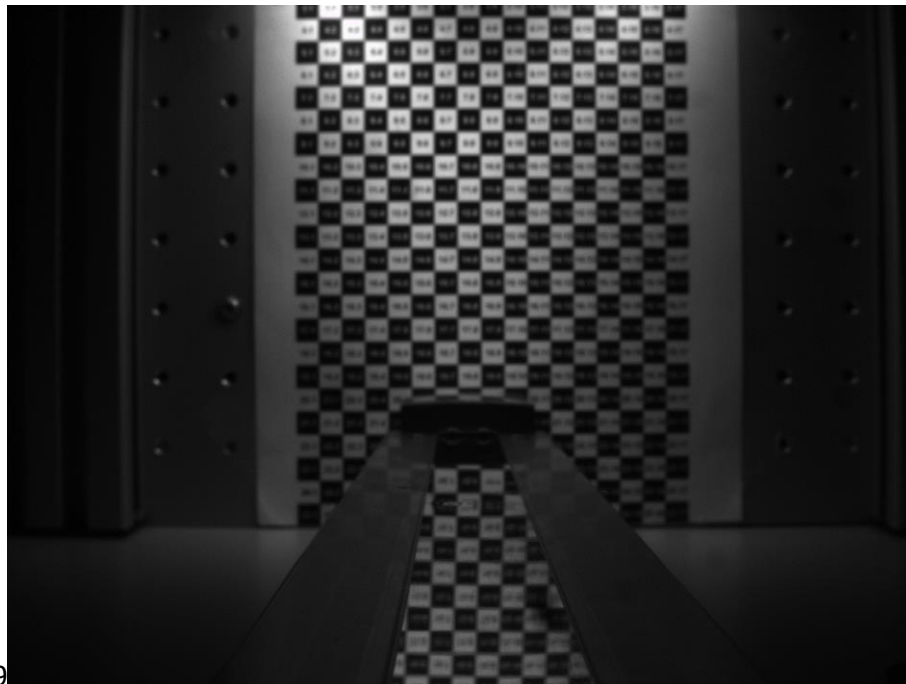
Figura A2.3 Pior resultado de Focus Metric (valor de 10,2) e distância acima de d_0 , com filtro verde
