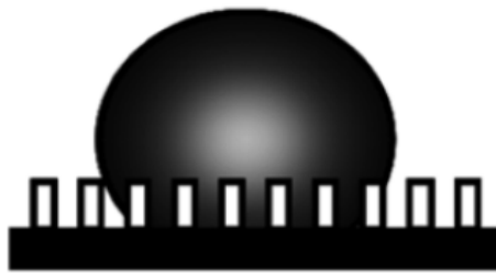
Figura 4 – Representação do comportamento de uma gota sobre uma superfície superhidrofóbica pelo modelo de Wenzel (Gong et al., 2010)
