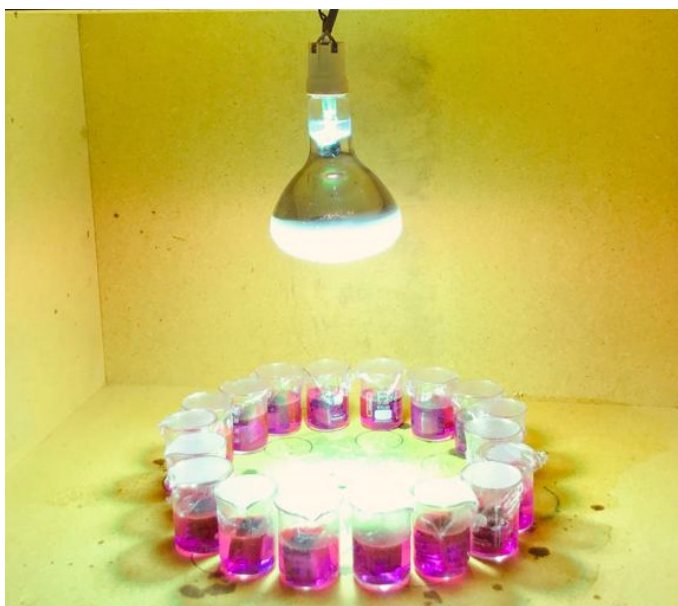
Figura 17 – Câmara de simulação de irradiação de luz UV
