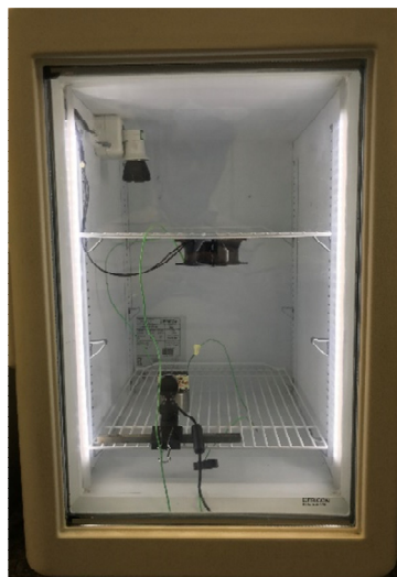
Figura 16 – Frigorífico adaptado com câmera de alta resolução e termômetro
