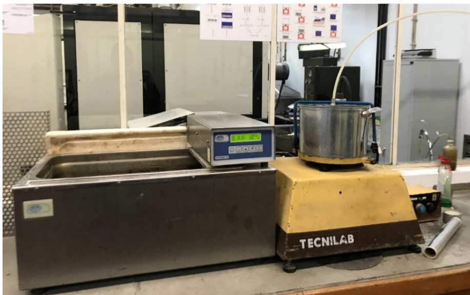
Figura 14 – Picnómetro utilizado para a determinação da BMT (procedimento volumétrico)
