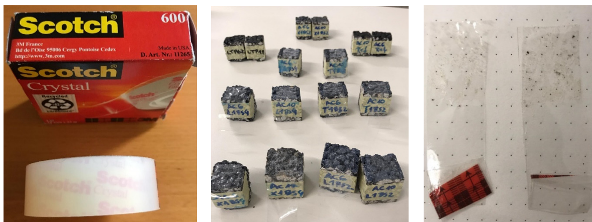
a) Fita-cola utilizada no ensaio b) Fita-cola aplicada nos provetes c) Massa retida na fita-cola Figura 19 – Ensaio da fita-cola para verificar a adesão do revestimento à superfície betuminosa
