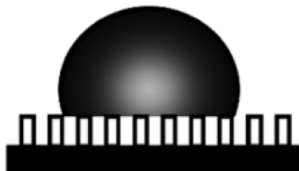
Figura 5 – Representação do comportamento de uma gota sobre uma superfície superhidrofóbica pelo modelo de Cassie-Baxter (Gong et al., 2010)
