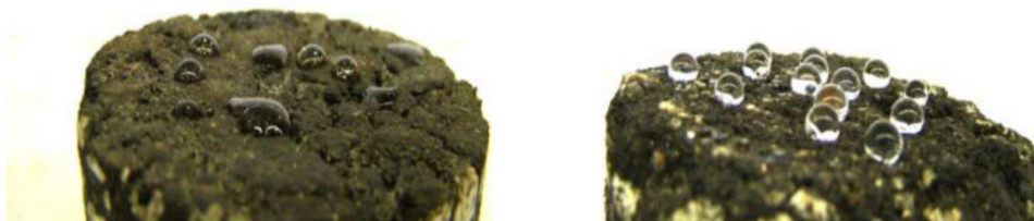
Figura 8 – Comportamento das gotas de água em superfície betuminosa não revestida (esquerda) e revestida (direita) com CaO (Nascimento et al., 2012)
