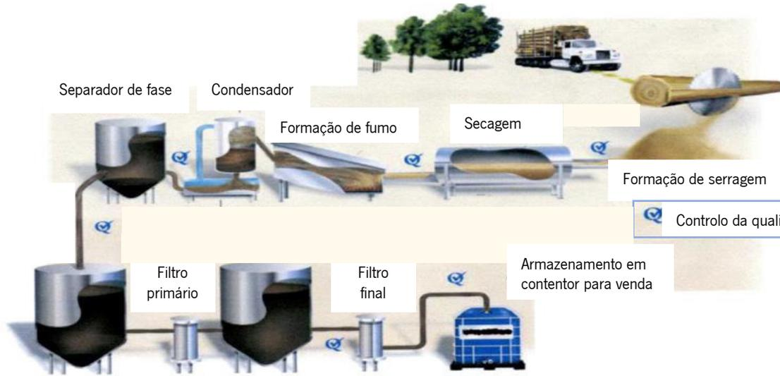
Figura 16. Diagrama da produção do fumo líquido (adaptado de Lingbeck *et al.*, 2014).
