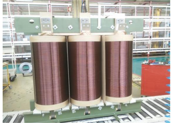
Figura 9. Fotografia do núcleo trifásico do transformador em estudo.
