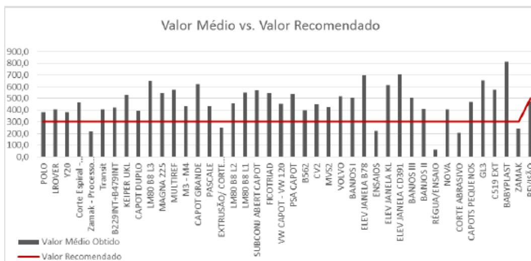
Figura 11 - Gráfico de comparação dos valores médios obtidos de iluminância com aos valores recomendados.
