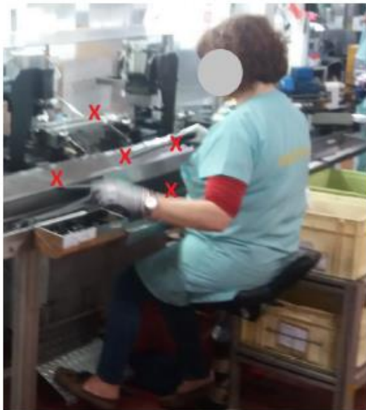
Figura 1 - Pontos de medição da iluminância no posto de trabalho.
