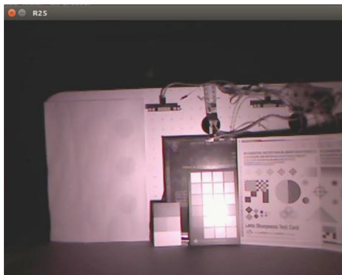
Figura 101. Resposta do Sensor R25 ao LED IR 740 nm .
