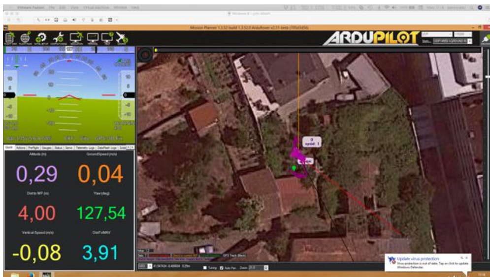
Figura 126. Controlo de altitude, posicionamento GPS e trajeto percorrido (software Mission Planner ).
