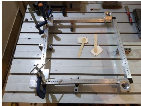
Figura 46. Processo de colagem dos componentes do chassis da Plataforma Móvel.
