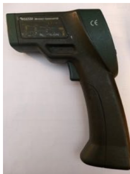
Figura 69. Sonda de temperatura Mastech Ms6530 por PIR.
