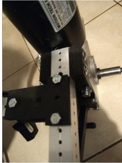
Figura 45. Teste de prototipagem e montagem da plataforma utilizando peças primariamente fabricadas através do processo aditivo (impressora 3D).
