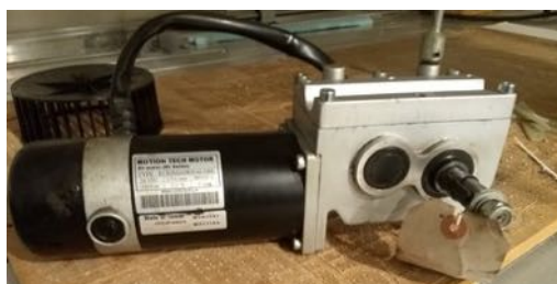
Figura 39. Fotografia ao motor Motion Tech Ec Series , utilizado na Plataforma Móvel.
