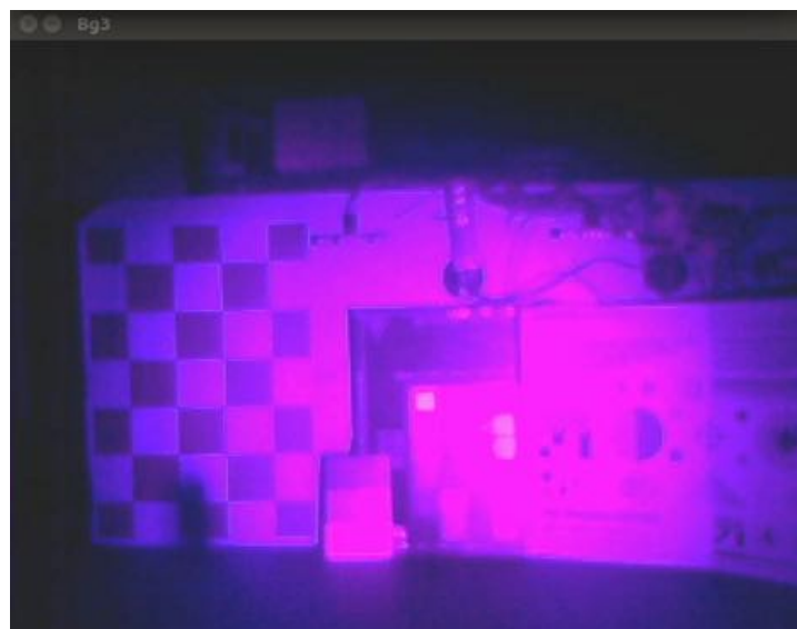
Figura 99. Resposta do Sensor BG3 ao LED UV .
