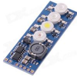
Figura 66. Placa com LEDs canal único: branco, vermelho, verde e azul.
