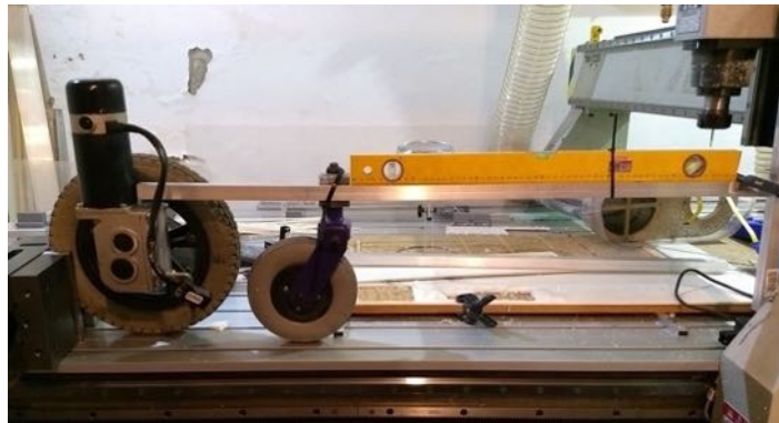
Figura 40. Obtenção de dados relativamente à altura dos equipamentos através de uma sonda de medição de altura integrada no equipamento de CNC .
