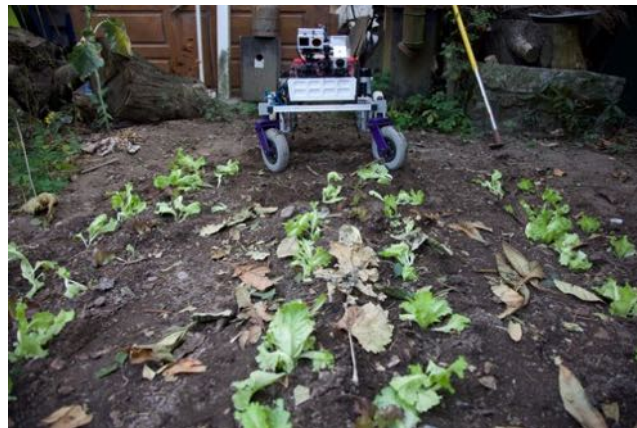
Figura 132. Plataforma Móvel a efetuar a análise em tempo real das trajetórias planeadas. a) Plataforma a efetuar o percurso planeado de folhas intercaladas com lajes; b) Adição de fruto fresco; c) Trajetória com introdução de ruído.
