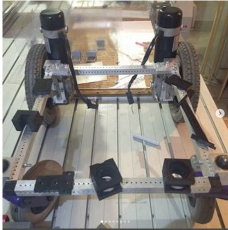
Figura 47. Processo de validação dos componentes criados por método aditivo, na Plataforma Móvel.
