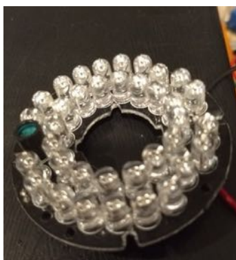
Figura 60. Array de LEDs infravermelhos, desenvolvido especificamente para esta dissertação.
