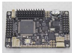
Figura 36. Placa APM 2.5 utilizada na monitorização e controlo do sistema.
