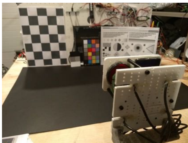
Figura 88. Calibração do Grupo Ótico através da utilização de alvos de calibração.
