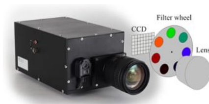
Figura 19. Câmara multiespectral obtida através da utilização de uma roda de filtros [20].
