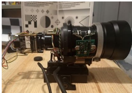
Figura 139. Modificação de lente de ampliação, acoplada ao Grupo Óptico, com a finalidade de aquisição e focagem em objetos e/ou zonas restritas.
