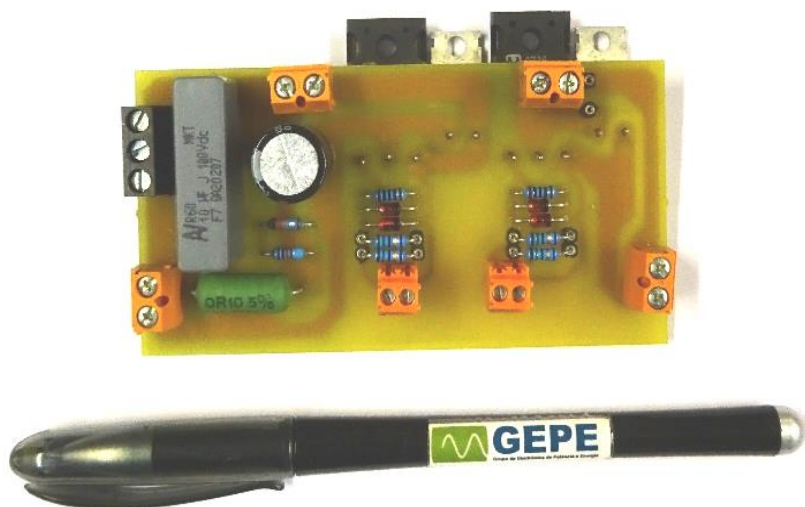
Figura 5.25 - Placa desenvolvida para o conversor CC-CC.
