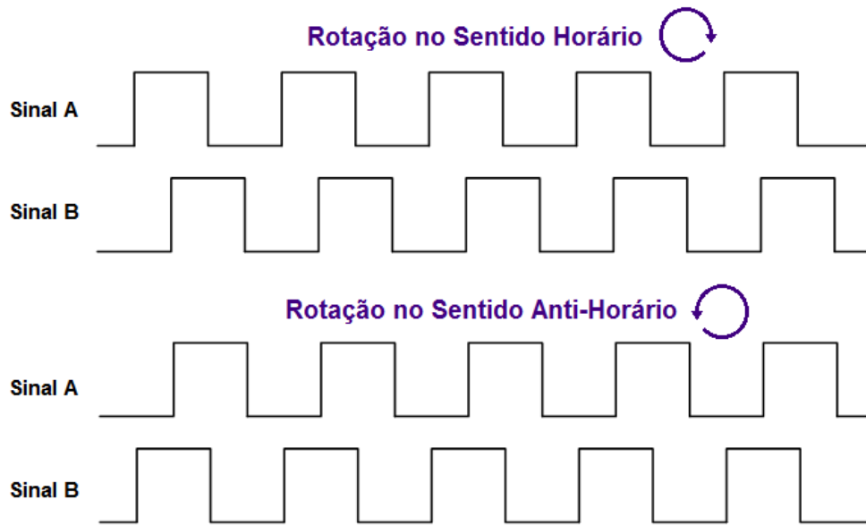
Figura 2.15 - Sinais de saída do sensor óptico incremental.
