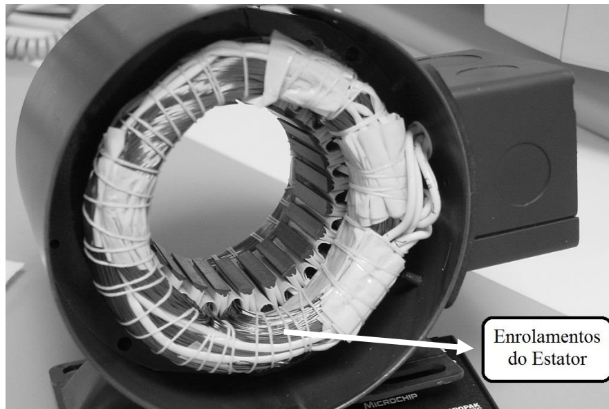
Figura 2.4 - Estator de um Motor BLDC (adaptado de [30]).
