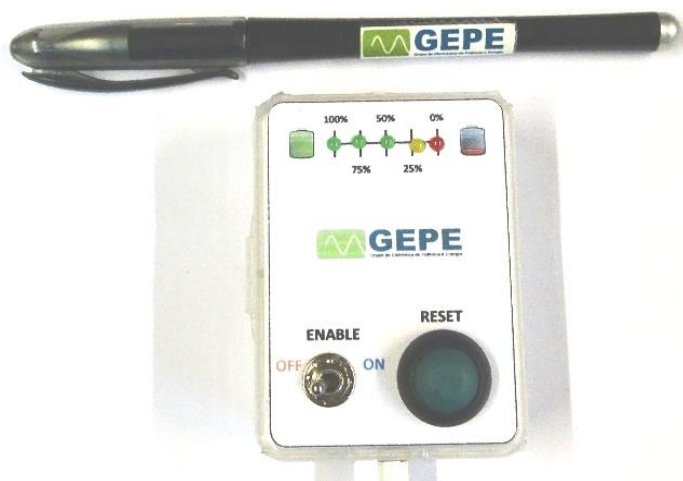
Figura 5.19 - Caixa de comando desenvolvida.
