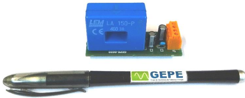
Figura 5.9 - Sensor de corrente de efeito Hall LA 150-P da LEM .
