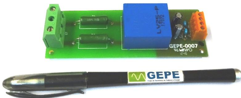
Figura 5.6 - Sensor de tensão de efeito Hall LV-25-P da LEM .
