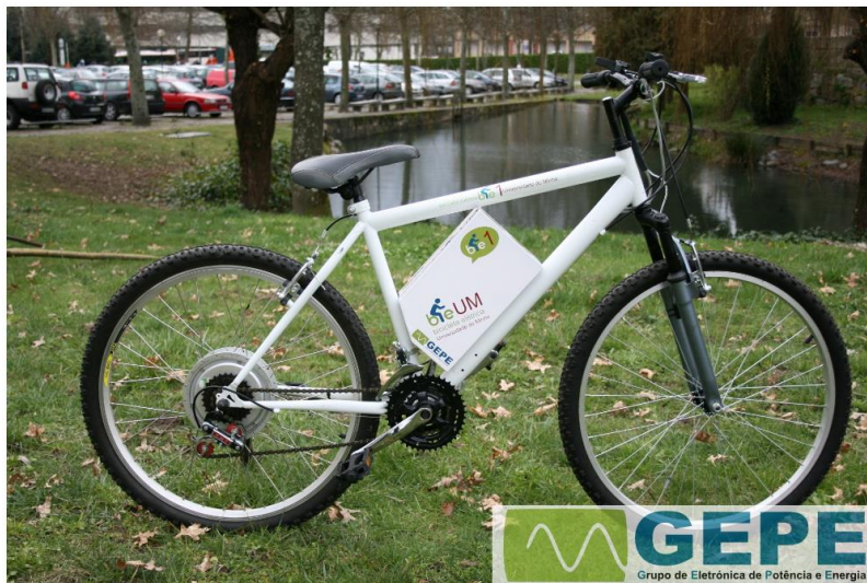
Figura 5.35 - Bicicleta elétrica BeUM desenvolvida no GEPE [76].
