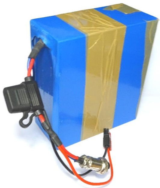
Figura 5.34 - Bateria de polímero de lítio utilizada.
