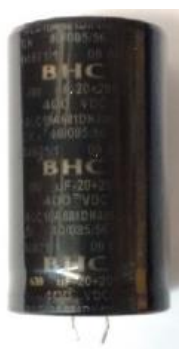
Figura 5.28 - Condensador eletrolítico utilizado no barramento CC.
