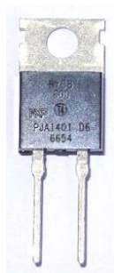
Figura 5.26 - Díodo BYC8-600 da NXP Semiconductors .
