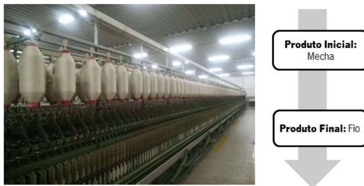
Figura 3.9- Contínuo da empresa SMBM cheio com carretos.
