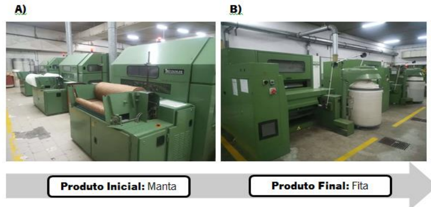
Figura 3.6 - Carda: A) Zona da carda onde é colocada a manta; B) Zona da carda onde sai a fita.
