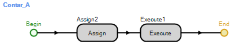
Figura 23: Processo usado para contar o número de ModelEntities que passam pelo Corredor_A e para diminuir a velocidade do Worker .
