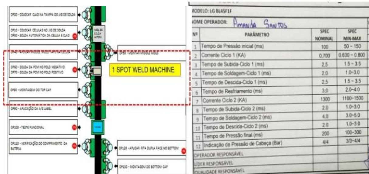
Figura 24: Processo Modificado e Estudo do Perfil da Máquina - Fonte: o próprio autor
