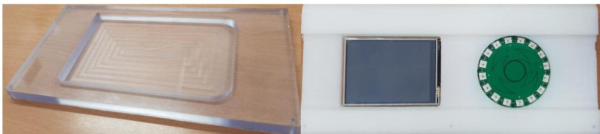
Figura 4.5: Tampa superior modelada em policarbonato transparente compacto e tampa frontal com o LCD e o touch
