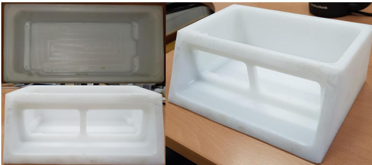
Figura 4.1: Caixa do biorreator modelada em PEAD
