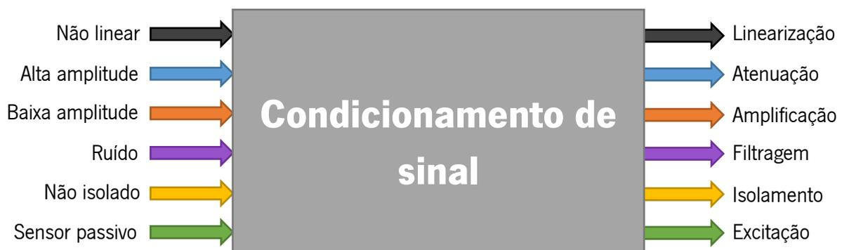
Figura 2.22: Operações de condicionamento de sinal [41]
