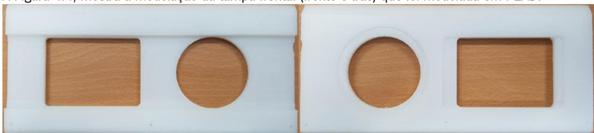
Figura 4.4: Tampa frontal do biorreator modelada em PEAD
