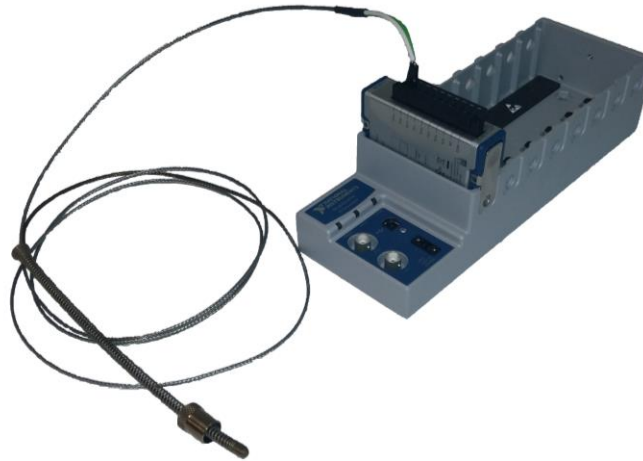
Figura 3.10: Setup de montagem do termopar utilizando o NI-9211.
