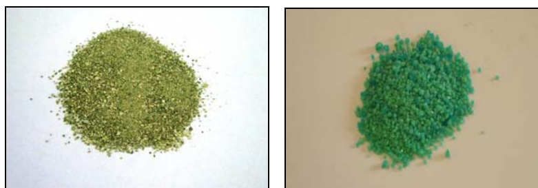
Figura 7.2 – Imagens do sal produzido após a cristalização evaporativa da solução 1 (à esquerda) e do NiSO 4 comercial (à direita).
