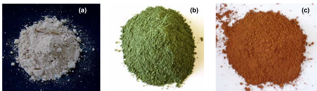
Figura 3.7 – Exemplos de lamas galvânicas, sendo: (a) lama do processo de anodização de alumínio; (b) lama galvânica rica em níquel e crómio e (c) lama galvânica rica em ferro.
