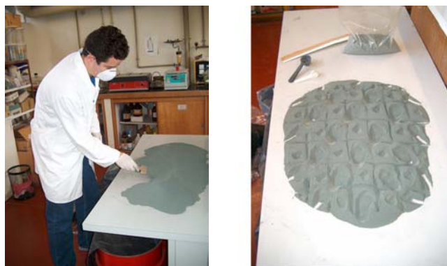
Figura 3.8 – Homogeneização de todo o lote de lama, intercalada por sucessivas subdivisões e retiradas de amostras representativas de todo o lote.
