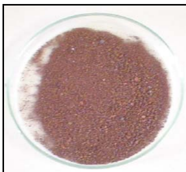
Figura 8.1 – Imagem de uma amostra do cimento de cobre produzida por cementação com pó de zinco.
