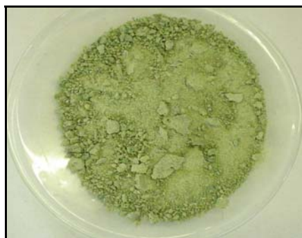
Figura 8.2 – Imagem de uma amostra de precipitado de crómio, obtida por precipitação com \text{CaCO}_3 .
