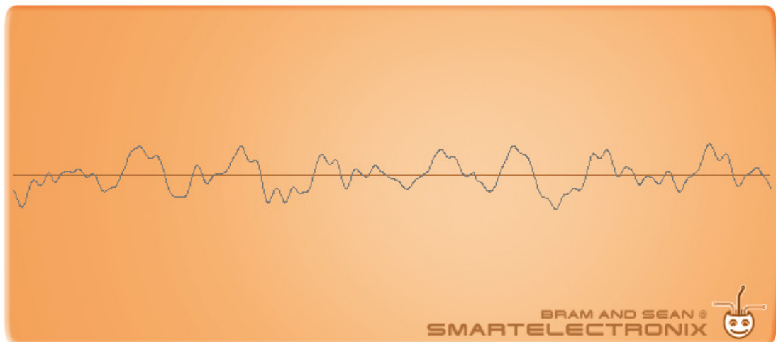
Ilustração 98 - Sinal à saída do compressor “GSSL” ( Makeup gain no máximo, Ratio 10)
