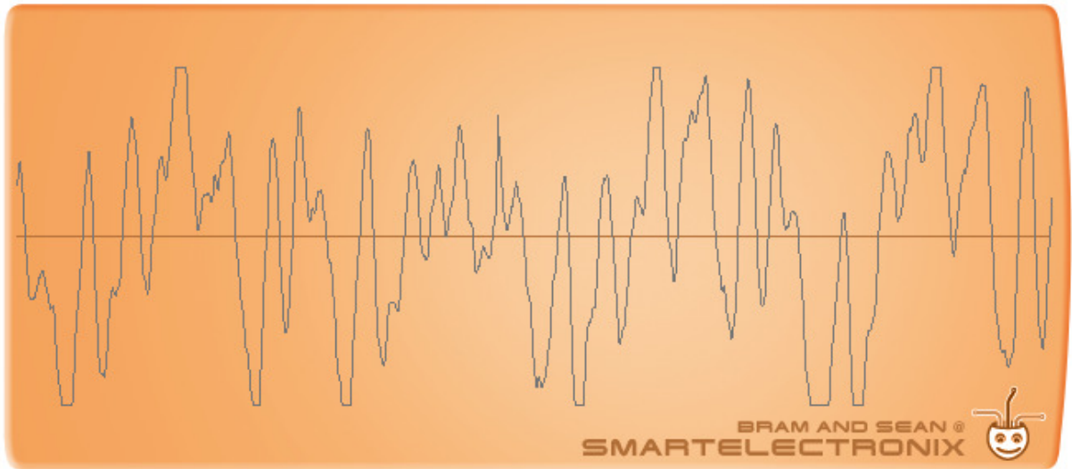
Ilustração 61 - Sinal à saída do pré amplificador "G9" (em saturação, com ganho no máximo)
