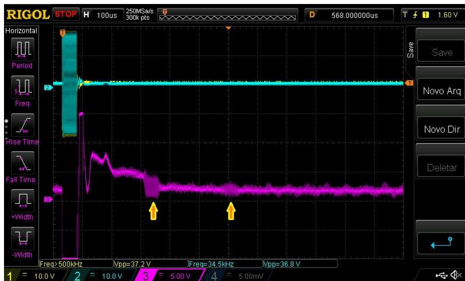
Figura 136 - Teste do amplificador inversor com o transdutor de 1,058MHz. A amarelo (CH1) e azul (CH2) os sinais de atuação do transdutor e a roxo (CH3) o sinal de saída do amplificador. Foram sensorizados dois ecos, assinalados com as setas laranjas.
