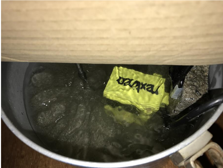
Figura 36 - Setup da medição de estufa a causar problemas nas medições. O facto de o misturador mecânico estar a girar a uma grande velocidade, necessária para manter as partículas em suspensão, criaria um vórtice de fluxo de sedimentos. Estando o sensor virado para o interior do recipiente, fazia com que a zona de sensorização não apanhasse esse mesmo fluxo.
