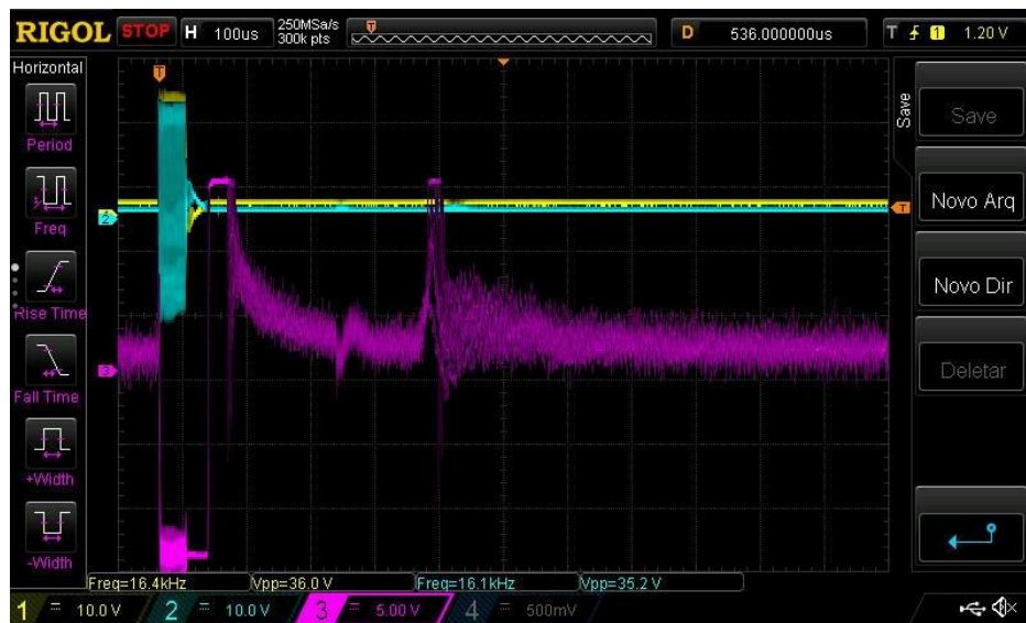
Figura 135 - Teste do amplificador de carga com o transdutor de 2,404MHz. A amarelo (CH1) e azul (CH2) os sinais de atuação do transdutor e a roxo (CH3) o sinal de saída do amplificador.
