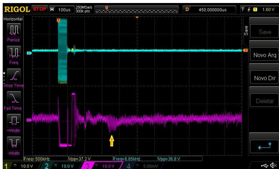
Figura 134 - Teste do amplificador de carga com o transdutor de 1,058MHz. A amarelo (CH1) e azul (CH2) os sinais de atuação do transdutor e a roxo (CH3) o sinal de saída do amplificador. A seta laranja identifica o eco recebido.
