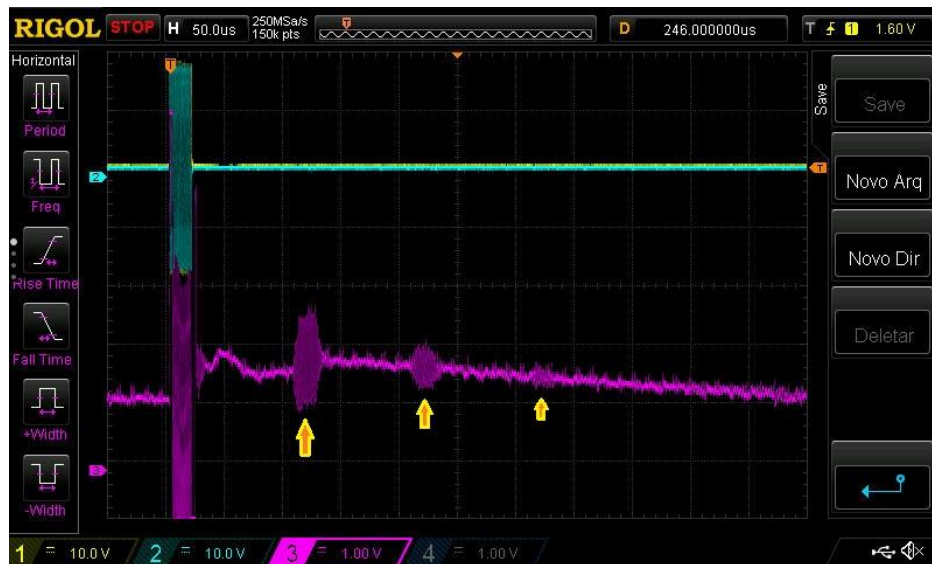
Figura 138 – Teste do amplificador de instrumentação com o transdutor de 1,058\text{MHz} . A amarelo (CH1) e azul (CH2) os sinais de atuação do transdutor e a roxo (CH3) o sinal de saída do amplificador. Foram sensorizados três ecos, assinalados com as setas laranjas.
