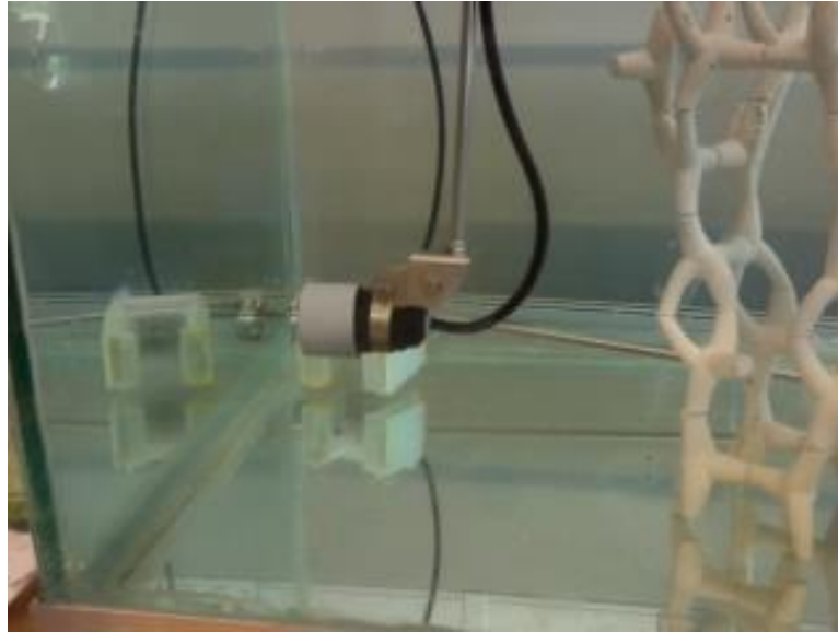
Figura 133 - Setup dos testes para sintonização dos módulos de recepção.
