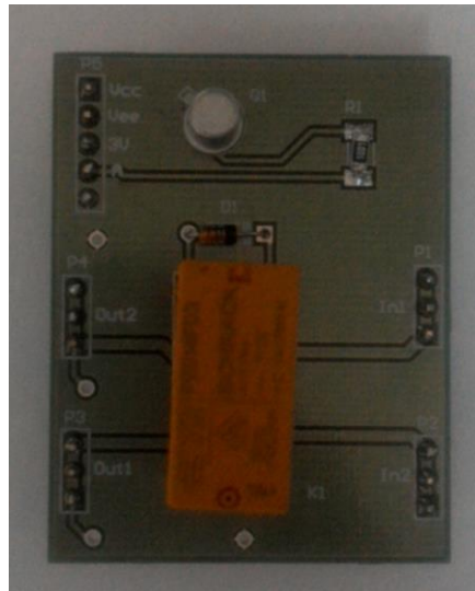
Figura 86 - Circuito impresso do circuito do relé.
