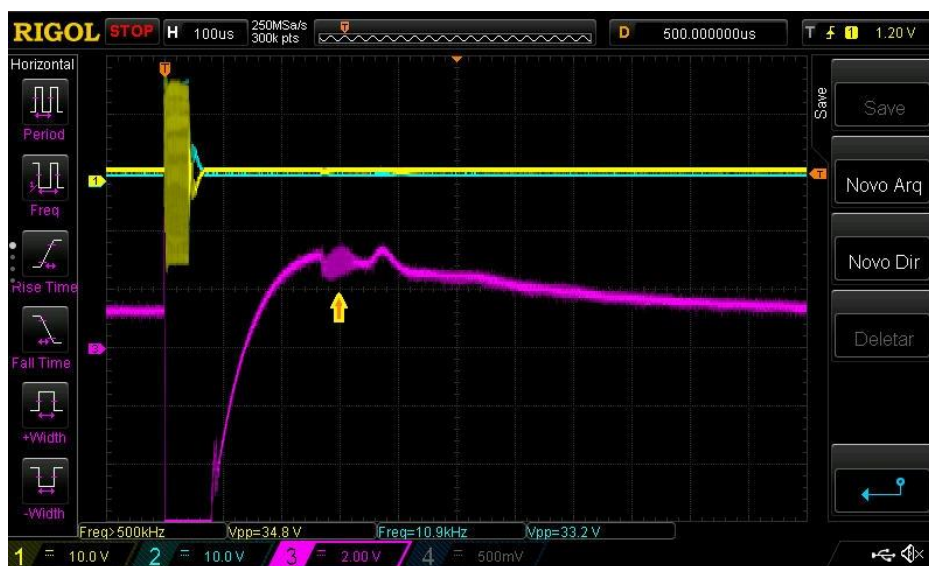
Figura 137 - Teste do amplificador inversor com o transdutor de 2,404MHz. A amarelo (CH1) e azul (CH2) os sinais de atuação do transdutor e a roxo (CH3) o sinal de saída do amplificador. A seta laranja identifica o eco recebido.
