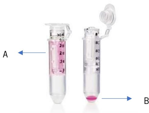
Figura 3.6 – Ilustração representativa do resultado obtido após a centrifugação dos Magnetolipossomas. A- Composto encapsulado; B- Composto não encapsulado. Adaptado de [19].
