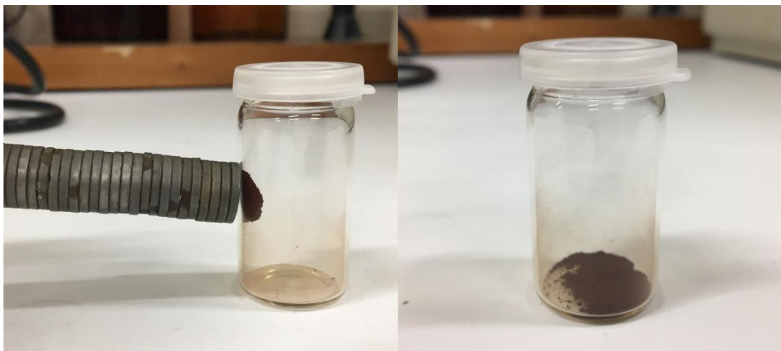
Figura 4.4 - Comportamento magnético das nanopartículas de ferrite de cálcio ( \text{CaFe}_2\text{O}_4 ) na presença (esquerda) e ausência (direita) de um campo magnético.
