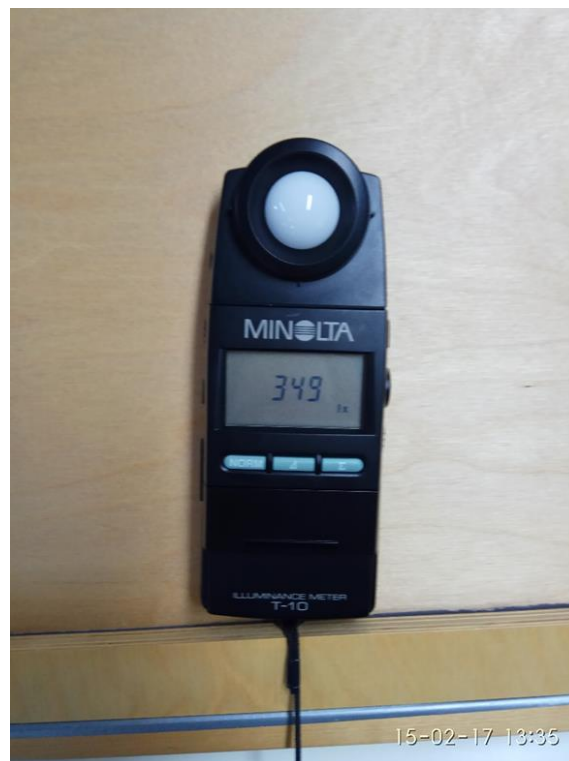
Figura 8. A figura mostra uma das medições da iluminância da área branca com o luxímetro, representada em lx e utilizada para calcular a luminância (aproximada) com base na fórmula: Luminância ( \text{cd}/\text{m}^2 ) = Iluminância ( \text{lx} ) x refletância / \pi , considerando a refletância do papel branco 95% Neste caso, esta iluminância corresponde a aproximadamente 106 \text{ cd}/\text{m}^2 estando dentro dos valores recomendados de luminância
