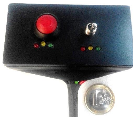
Figura 5.26 – Painel de comando e interface com o utilizador construído para o controlo do sistema.
