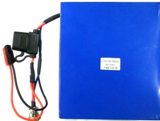
Figura 2.3 - Bateria de lítio polímero 36 V, 10 Ah, utilizada na bicicleta elétrica.
