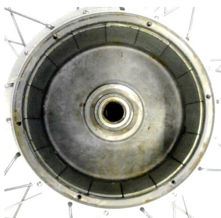
Figura 2.12 - Rotor de um motor BLDC.
