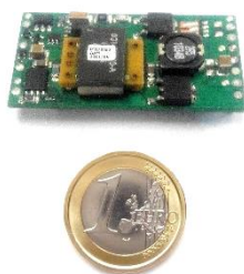
Figura 5.19 - Conversor CC/CC usado na alimentação do circuito digital de controlo da segunda versão do controlador.
