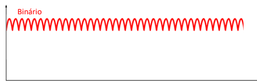
Figura 2.15 - Binário total produzido por um motor BLDC.
