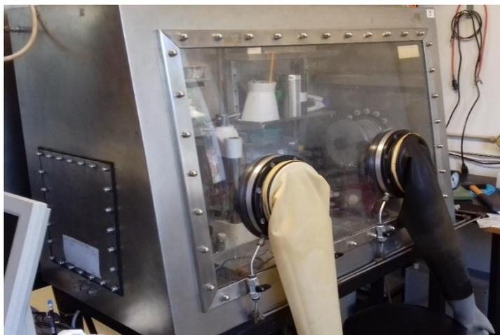
**Figura 3.11:** Caixa de luvas com atmosfera de árgon, utilizada na montagem das baterias.
