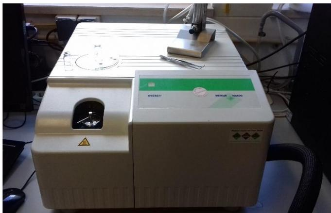
**Figura 3.10:** Equipamento utilizado na DSC.
