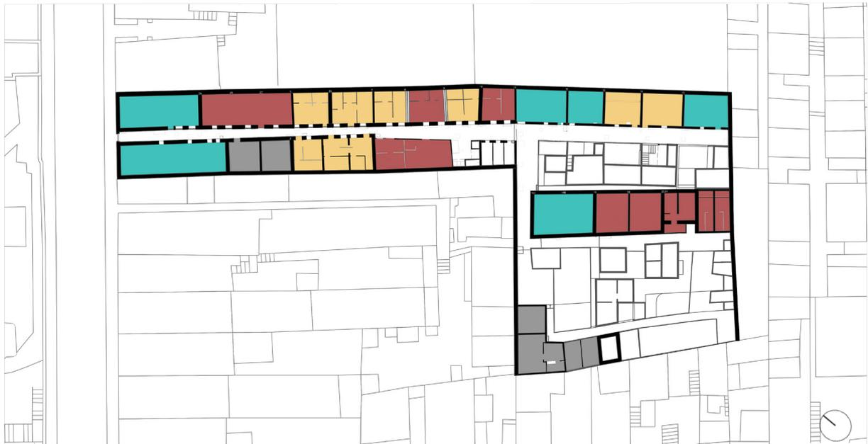
FIG.27- Planta de piso e estado de degradação
