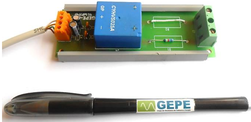
Figura 5.33 – Placa para um sensor de tensão CYHVS025A (desenvolvida pelo GEPE).
