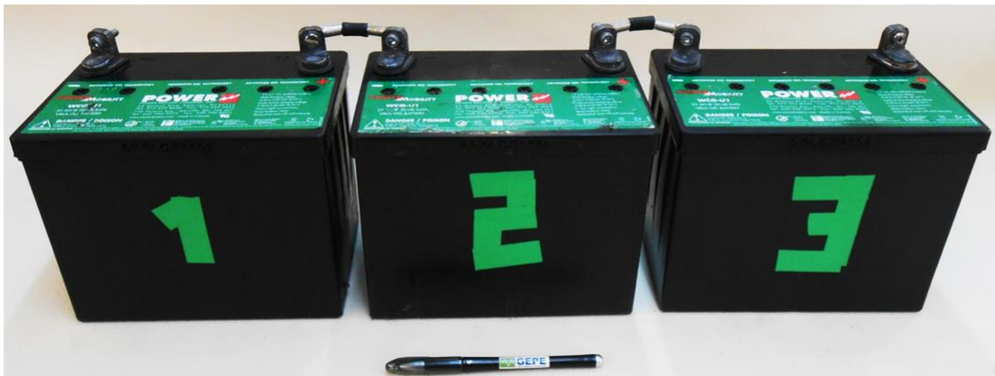
Figura 5.25 – Banco com três baterias de chumbo-ácido WCG-UI da Power Mobility em série.
