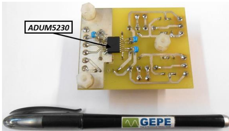
Figura 5.18 – Circuito em PCB da placa BMS (face inferior) desenhada para a solução 1.
