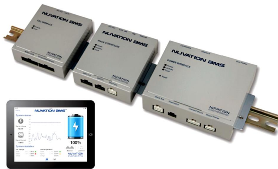
Figura 2.9 – Aspeto exterior do Nuvation BMS e interface com o utilizar para tablet [19].
