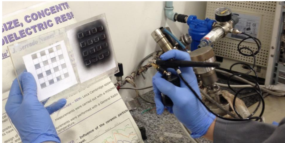
Figura 27 - Deposição da tinta na matriz de interdigitados.
