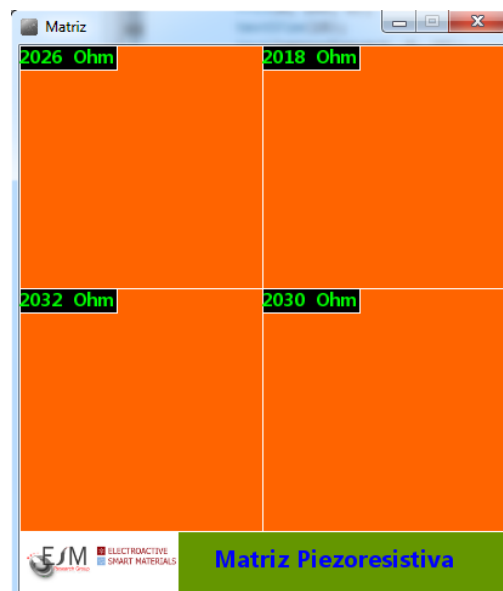
Figura 41 - Software desenvolvido para visualização das zonas de pressão na matriz.
