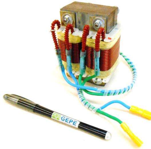
Figura 5.6 – Bobina de acoplamento com a rede elétrica.
