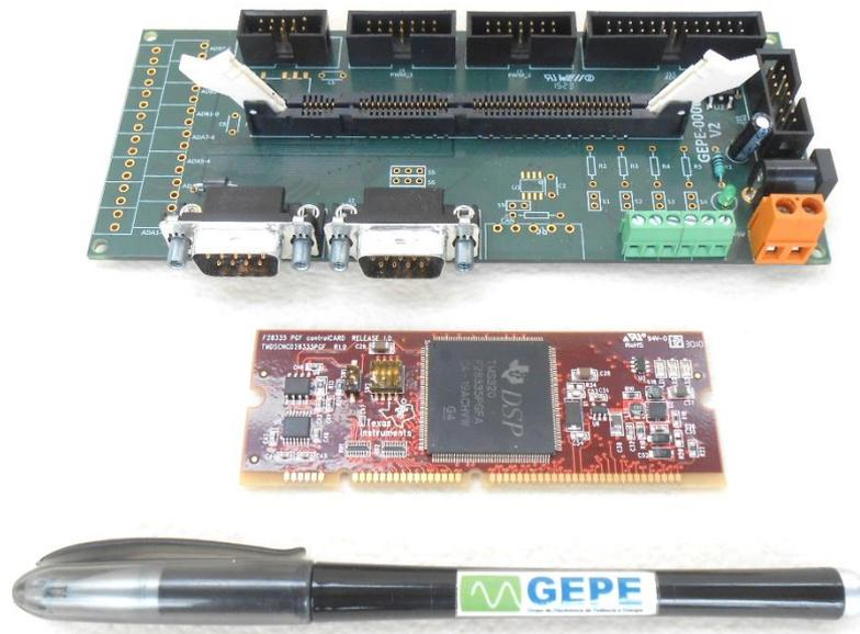
Figura 5.16 – DSC *TMS320F28335* e respetiva placa de suporte.
