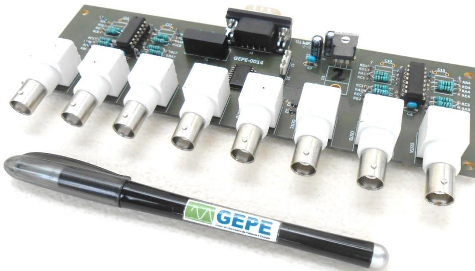
Figura 5.20 – Placa de DAC com oito saídas.
