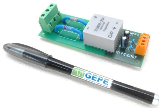
Figura 5.12 – Placa do sensor de tensão.
