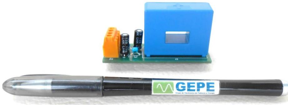
Figura 5.14 – Placa do sensor de corrente.
