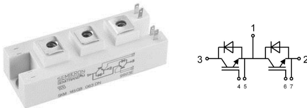
Figura 5.3 – Módulo de IGBT SKM 100GB176D e respetivo circuito interno [45].
