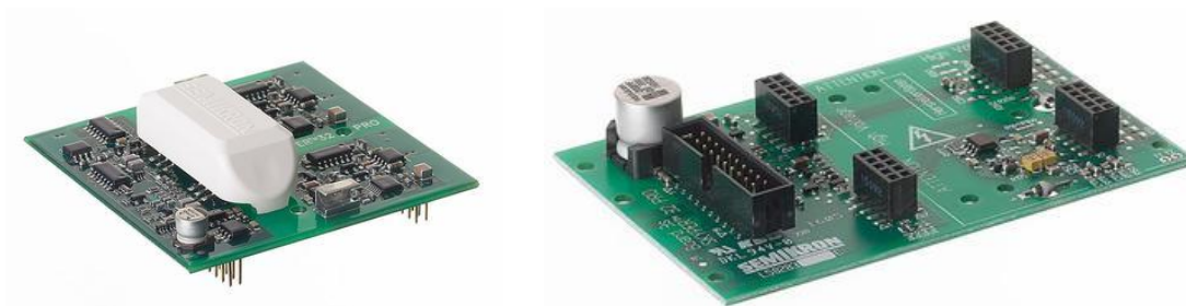
Figura 5.2 – Driver SKIPER 32Pro R [46] e respetiva placas de configuração Board 1 SKIPER 32Pro R [47].
