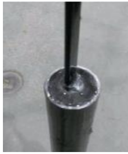
Figura 2.10 - Ensaio de tração uniaxial a elevadas temperaturas em laminados embebidos em resina epoxy.
