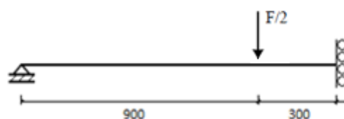
Figura 3.2 - Esquema estrutural usado para a modelação das vigas.
