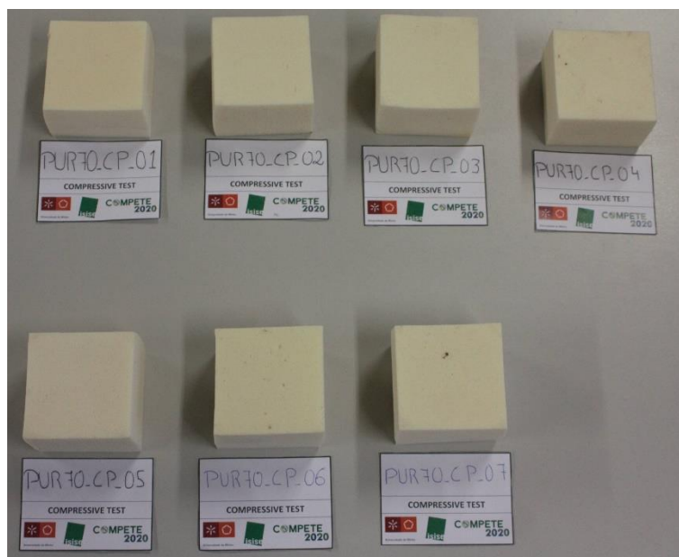
Figura 3.13 - Provete ensaiados à compressão. Nota: a fotografia foi tirada algum tempo depois da realização dos ensaios, por isso estes, apresentam, por isso estes, a recuperação da deformação elástica.
