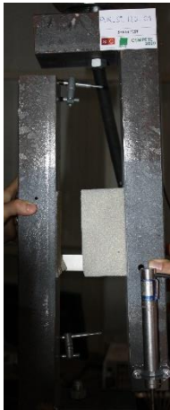
Figura IV.1 (cont.) - Modos de rotura dos PUR_ST_60_120 (Grupo II): (a) PUR_ST_60_120_01 e (b) PUR_ST_60_120_02.
