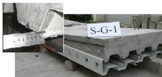
Figura 2.24 - Modo de rotura no painel sem tratamento da interface e pormenor do deslizamento entre as componentes de GFRP e betão (adaptado de (Liu et al. , 2011)).
