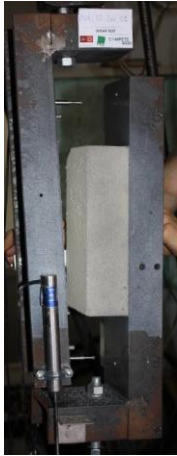
Figura IV.1 (cont.) - Modos de rotura dos PUR_ST_60_240 (Grupo II): (a) PUR_ST_60_240_01 e (b) PUR_ST_60_240_02.
