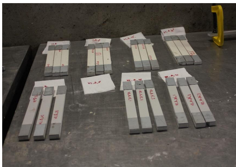
Figura 4.8 - Provetes extraídos das vigas 1 e 2, das quais se extraíram os provetes: na parte superior da imagem encontram-se os provetes retirados da viga 1 e na parte de baixo os provetes retirados da viga 2.
