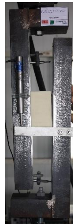
Figura IV.1 (cont.) - Modos de rotura dos PUR_ST_60_120 (Grupo II): (a) PUR_ST_60_120_01 e (b) PUR_ST_60_120_02.
