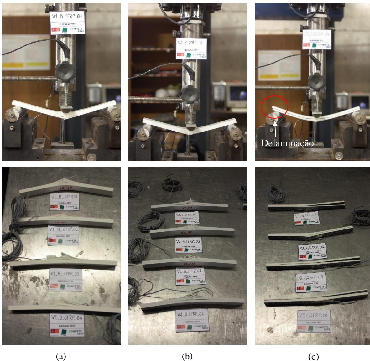
Figura 4.6 - Modos de rotura obtidos referentes a cada série. Em cima encontra-se um provete de cada série durante a fase final do ensaio e em baixo encontram-se todas os provetes após o ensaio do mesmo: (a) provetes da Série 1; (b) Série 2 e (c) Série 3. Nota: nas imagens relativas ao conjunto de provetes, importa referir que o nível de rotura se encontra “ampliado” relativamente ao ensaio padrão, uma vez que todos os provetes foram continuamente carregados com o objetivo de amplificar o padrão de rotura.
