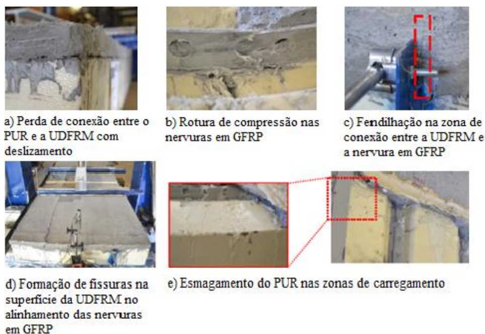
Figura 2.27 - Sequência de danos observada durante o ensaio do painel sanduíche híbrido proposto (adaptado de (Mastali et al. , 2015)).
