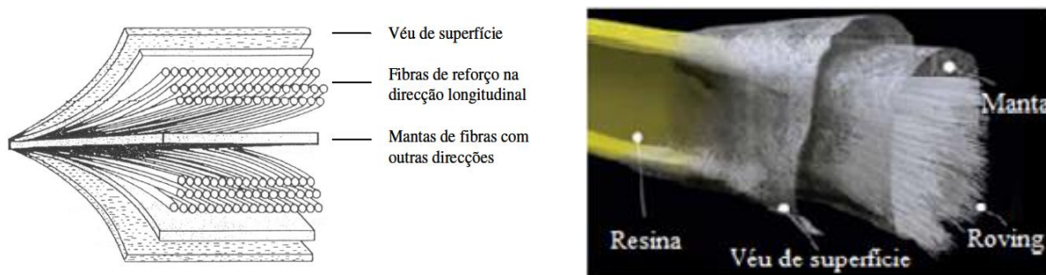
Figura 2.34 - Disposição típica das camadas num perfil pultrudido (esquerda e direita) (adaptado de (Correia, 2013)).
