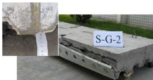
Figura 2.25 - Modo de rotura no painel com tratamento da interface e pormenor do deslizamento entre as componentes de GFRP e betão (adaptado de (Liu et al. , 2011)).
